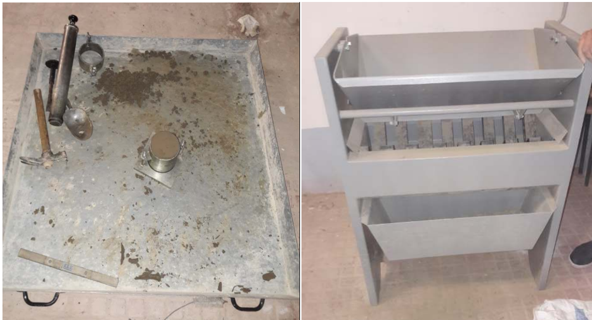
Figure 4.15 Vue générale de l'équipement de l'essai Proctor Normal
