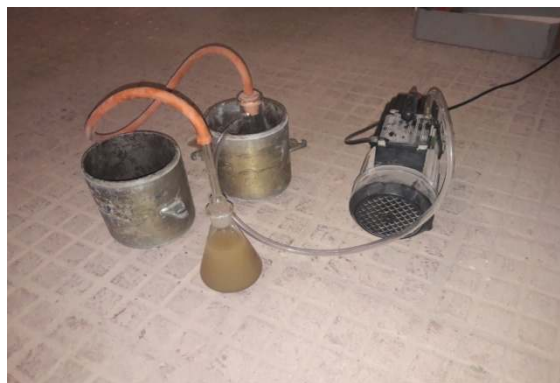
Figure 4.14 Vue générale de l'essai de pycnomètre à l'eau
