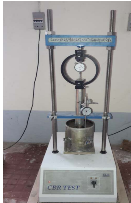
Figure 4.17 Vue générale de l'appareil utilisé dans l'IPI, l'I.CBR après immersion et l'I.CBR Immédiat.
