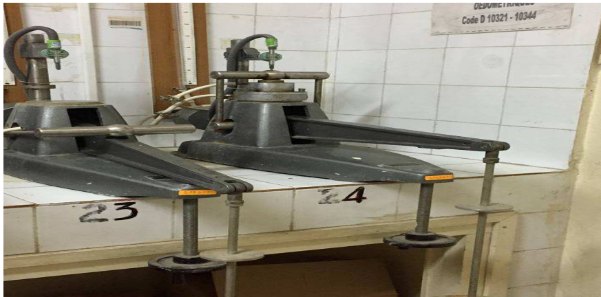
Figure 4.17: Les machines utilisées pour l'essai œdométrique laboratoire (L T P Est. Annaba).
