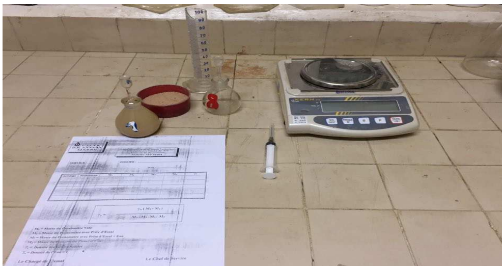
Figure4.8 : Matériel d'essai pycnomètre (L T P Est Annaba).
