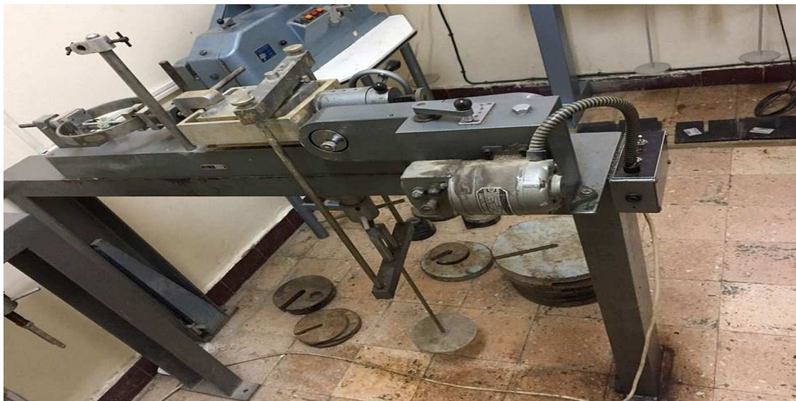
Figure4.14 : L'appareil de cisaillement direct (boite de Casagrande).
