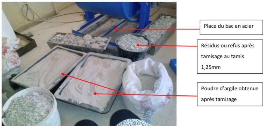
Photo V.16 : Résultats obtenues après passage à l'appareil de Los Angeles [12]
