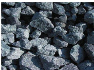
**Figure I.8** : Photo d'un laitier d'acier.
