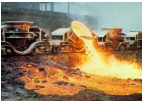
**Figure II.11:** Laitier en fusion coulé dans une fosse[57].
