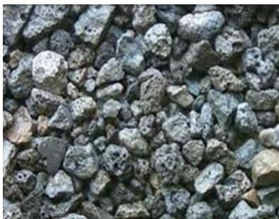
**Figure I.7** : Photo d'un laitier de haut fourneau.
