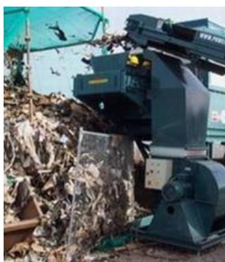
**FigureII.4:** Elimination des matériaux légers par jet d'air[4].
