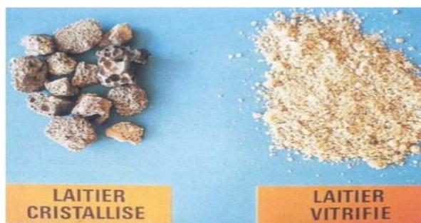
Figure II.10: Laitier cristallisé et laitier vitrifié granulé de haut fourneau [56].
