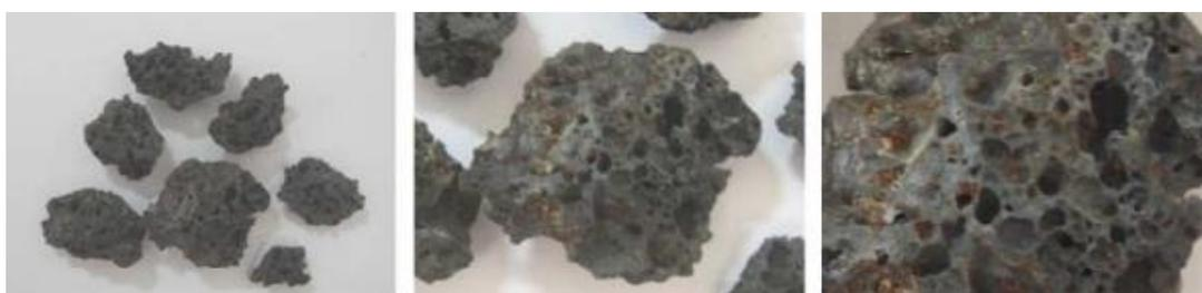
Figure II.12: Laitiers cristallin d'aciérie électrique ayant une structure poreuse et rugueuse[61].
