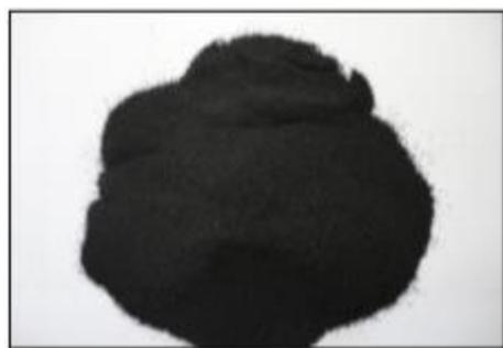
**Figure II.14 :** Granulats de caoutchouc[73].
