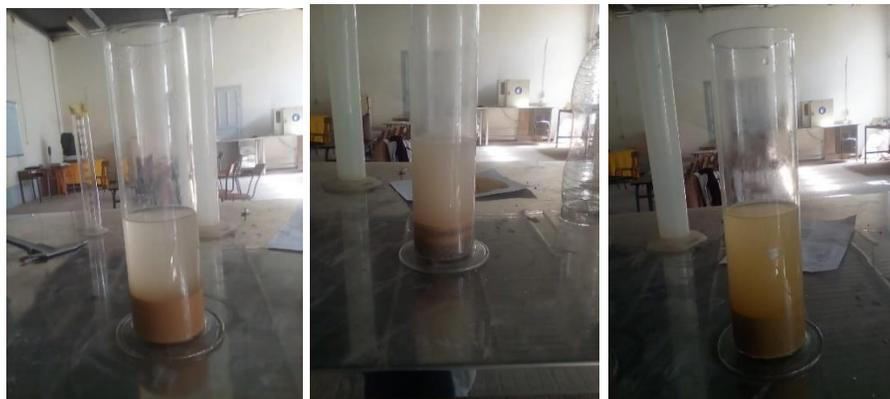
**Figure II.10.** Essai de la masse volumique absolue des sables utilisés.
