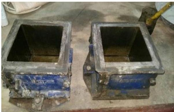
**Figure II.16.** Photo des moules cubiques utilisés.
