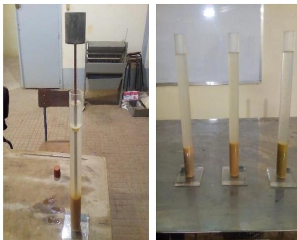
**Figure II.8.** Essai de l'équivalent de sable.
