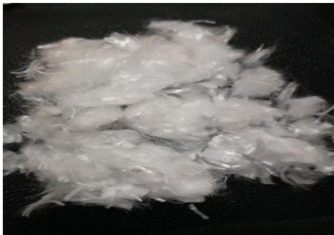
**Figure.14.** Photo des fibres de polypropylène utilisés.
