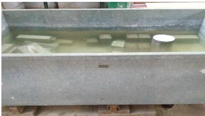
**Figure II.19.** Photo du bassin de la conservation des éprouvettes.
