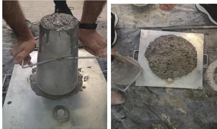
**Figure II.18.** Mesure de l'affaissement avec le cône d'Abrams.
