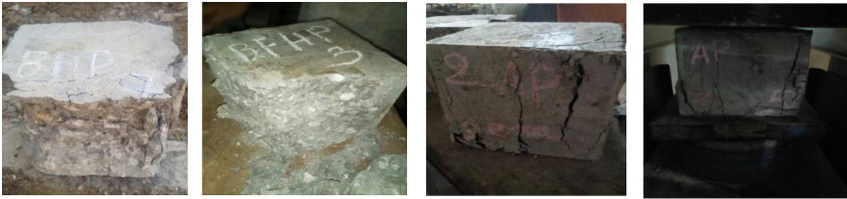
**Figure III.16.** Rupture des éprouvettes par compression à 250°C.
