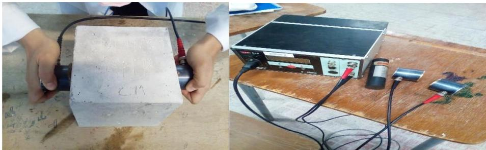
**Figure II.22:** Essai non destructif ultrasonique (transmission directe).
