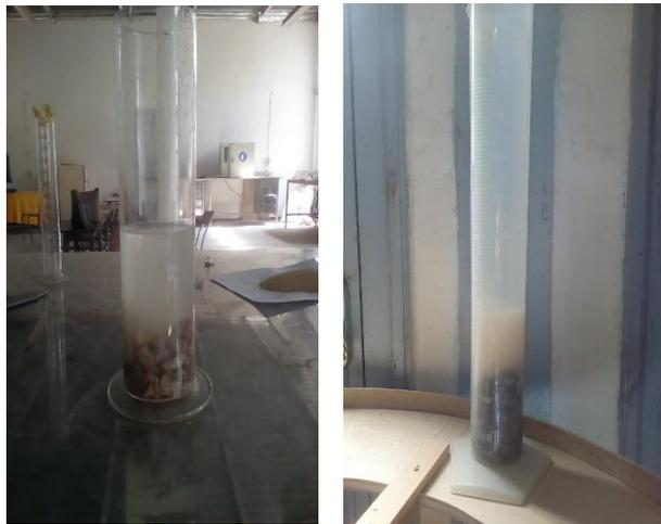
**Figure II.5.** Essais de la masse volumique absolue des graviers.
