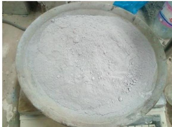
**Figure II.13.** Photo de la fumée de silice utilisée.
