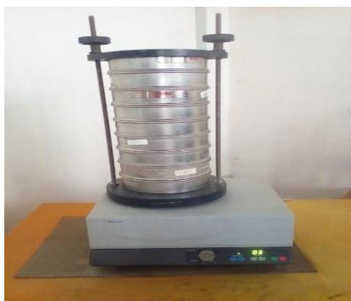
**Figure II.2.** Photo de la tamiseuse utilisée.
