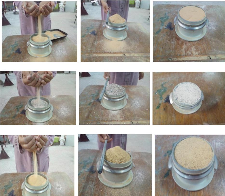
**Figure II.9.** Essais de la masse volumique apparent des sables utilisés.
