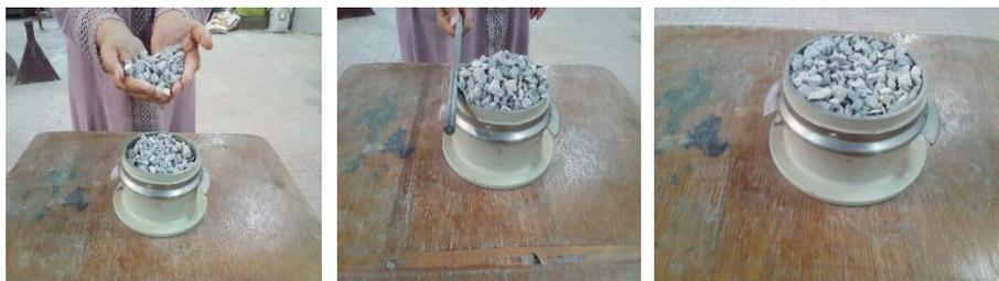
**Figure II.4.** Essais de la masse volumique apparente des graviers.
