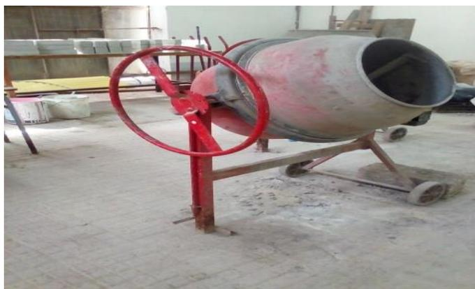
**Figure II.17.** Photo du malaxeur de béton utilisée.
