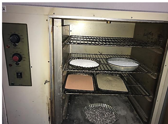
Figure II.16 : Séchage des charges minérales utilisées
