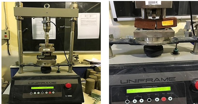
Figure II.22 : Essai de résistance à la flexion 3 points
