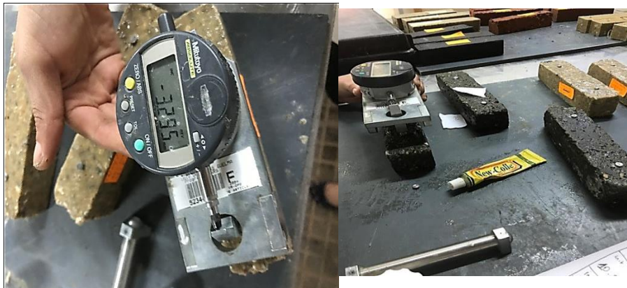
Figure II.19: Mesure de retrait
