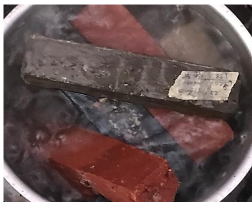
Figure II.20 : Porosité accessible à l'eau
