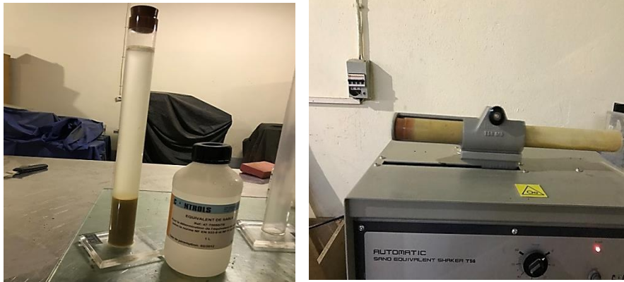
Figure II.15 : Essai d'équivalent de sable
