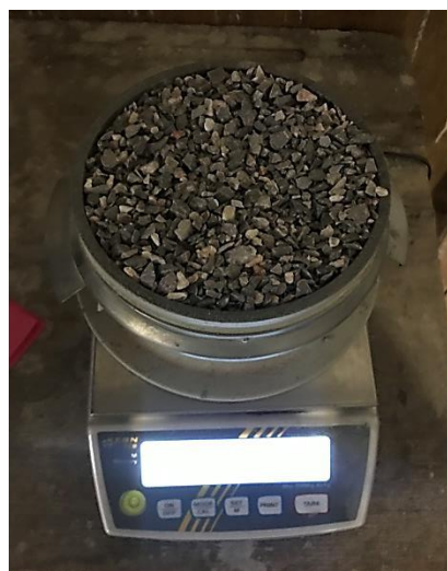
Figure II.12 : Masse volumique apparente du gravier
