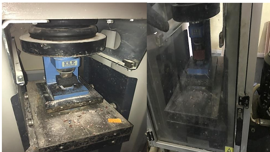
Figure II.23 : Essai de résistance à la compression
