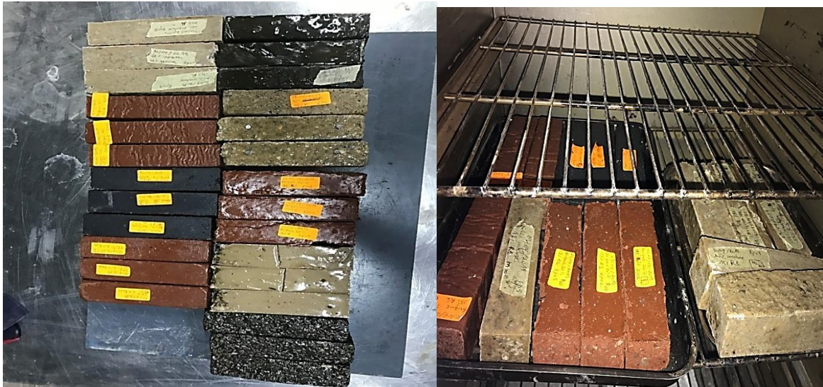
Figure II.18 : Traitement thermique des bétons polymères
