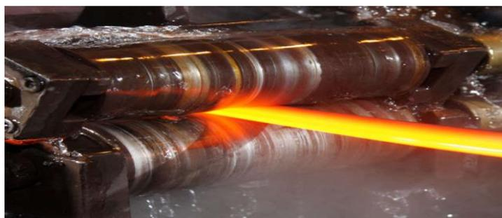
**Figure II.7 :** laminage de verre photovoltaïque
