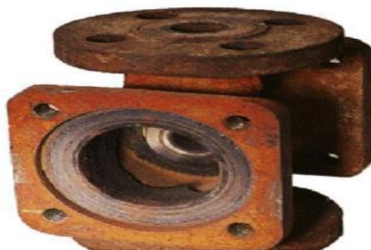
Figure I.1 : Corrosion générale (rouille) d'une pièce en acier [Habc, 13].
