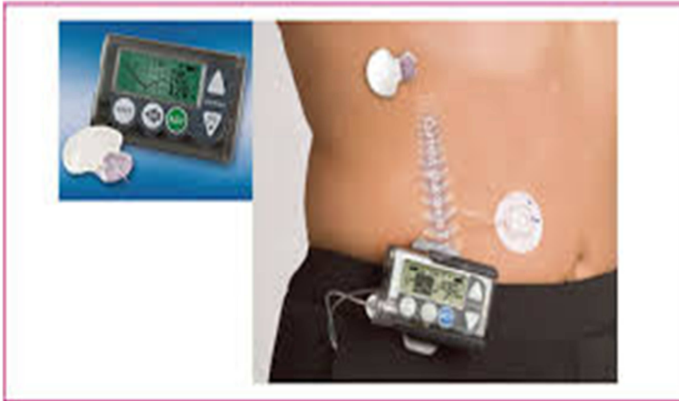
Figure II.7 Capteurs de glucose en continu Medtronic couplés à une pompe à insuline [21]
