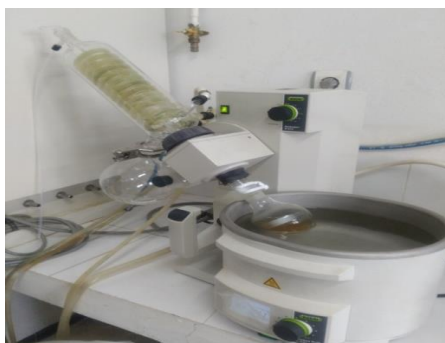
Figure 4.4 : Le montage de la distillation sous vide avec le rotavap.
