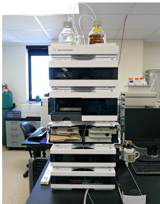
Figure A4.1 : Un chromatographe en phase liquide à haute performance moderne (agilent 1260 infinity).
