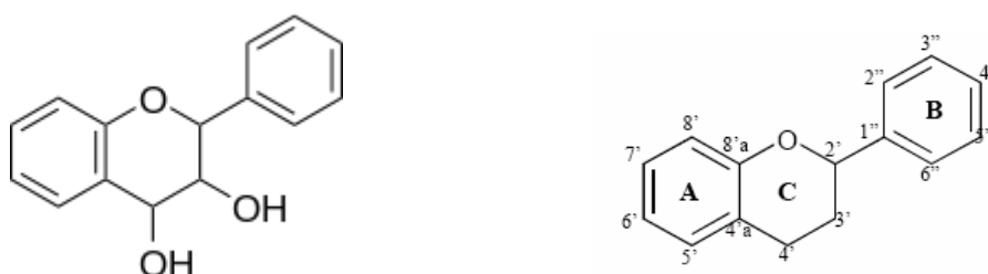
Figure 2.3 : Structure générale des flavonoïdes.
