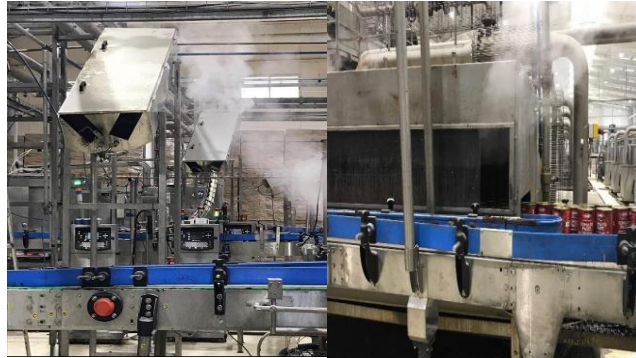
Figure 3.10 : Tunnel de stérilisation et de refroidissement.
