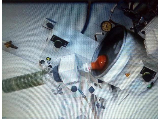
Figure 5.12: Concentration de tomate par rota-vapeur.
