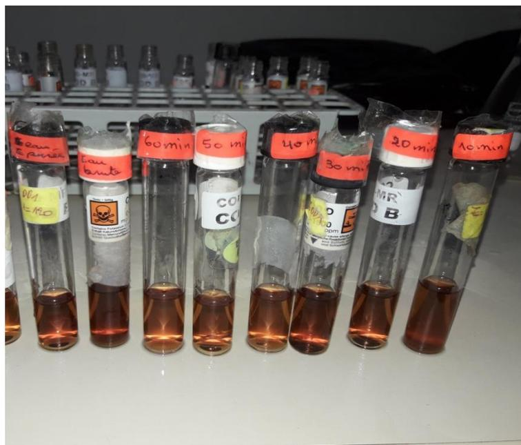
Figure IV-21 : Echantillons des différentes eaux (brute, traitée par boue activée et par électrocoagulation) après ajout de  $SO_4-1$ ,  $SO_4-2$ ,  $SO_4-3$  et  $SO_4-4$
