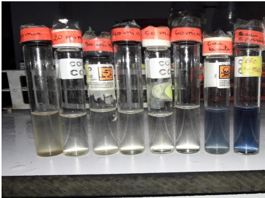
**Figure IV-22 :** Echantillons des différentes eaux (brute, traitée par boue activée et par électrocoagulation) après ajout des réactifs PO<sub>4</sub>-1 et PO<sub>4</sub>-2
