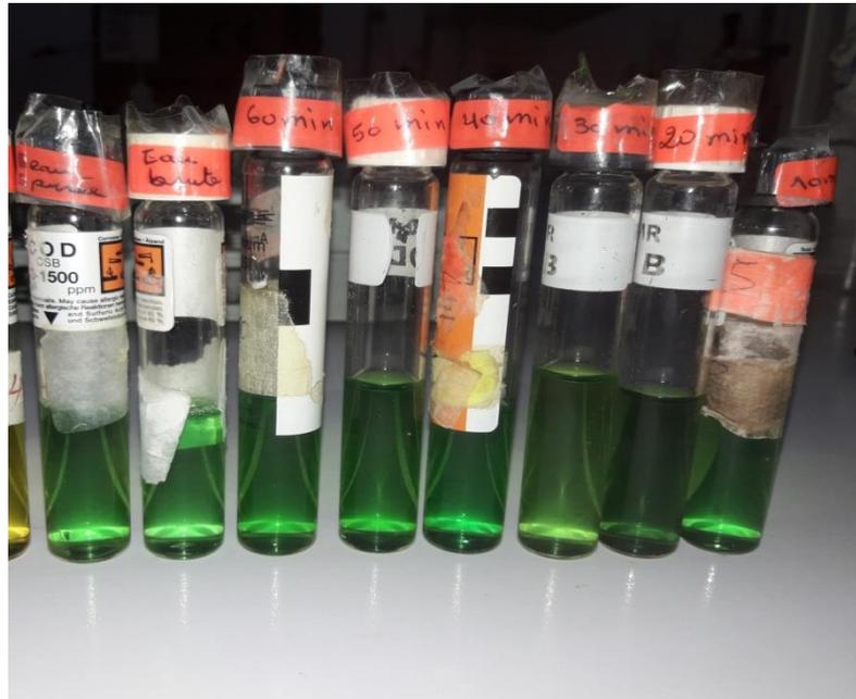
**Figure IV-16 :** Echantillons des différentes eaux (brute, traitée par boue activée et par électrocoagulation) après ajout de NH<sub>4</sub>-1, NH<sub>4</sub>-2 et NH<sub>4</sub>-3
