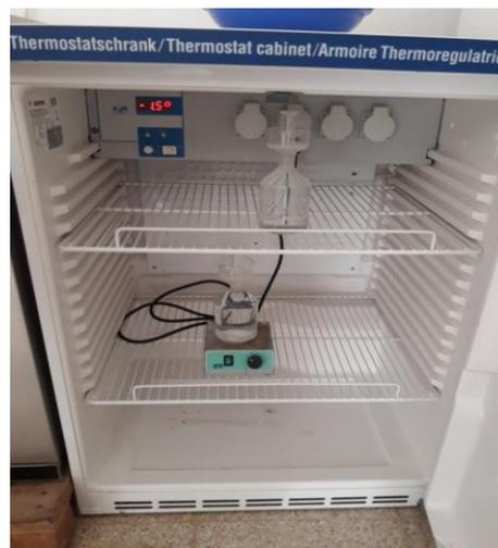
**Figure IV-12** : Photo montrant les échantillons dans le thermostat à 20°C pendant 5 jours.
