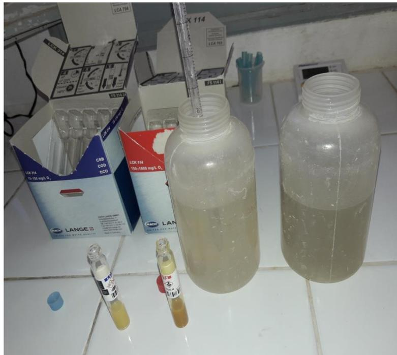
**Figure IV-14** : Photo montrant la manipulation pour la détermination d' $\text{OPO}_4^-$
