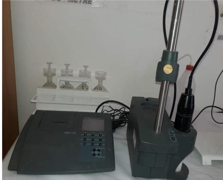
Figure IV-4 : Oxymètre utilisé pour la mesure de l'oxygène dissous
