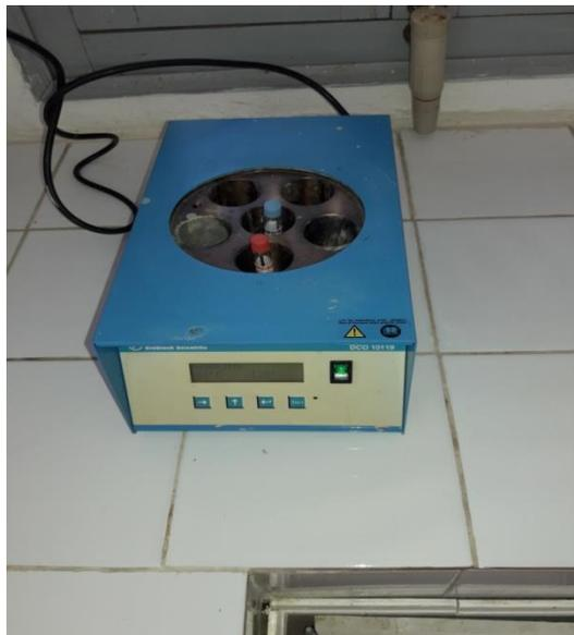
**Figure IV-9** : Réacteur utilisée pour la mesure de la DCO
