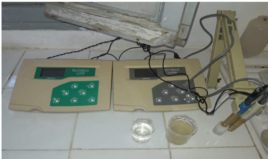
**Figure IV-3** : pH-mètre et conductimètre
