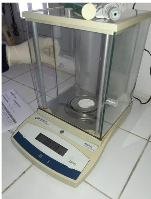
**Figure IV-6 : Balance analytique**
