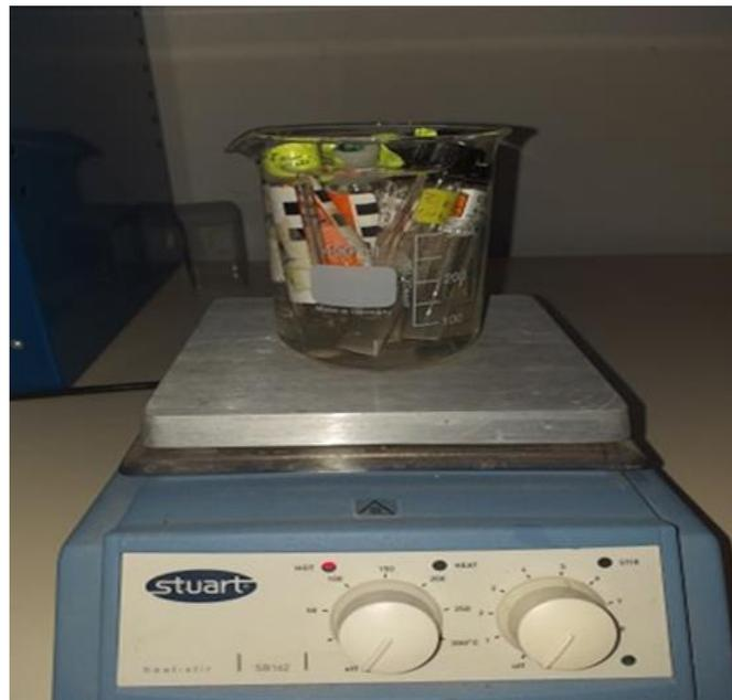
**Figure IV-19** : Bain-marie utilisé pour le chauffage
