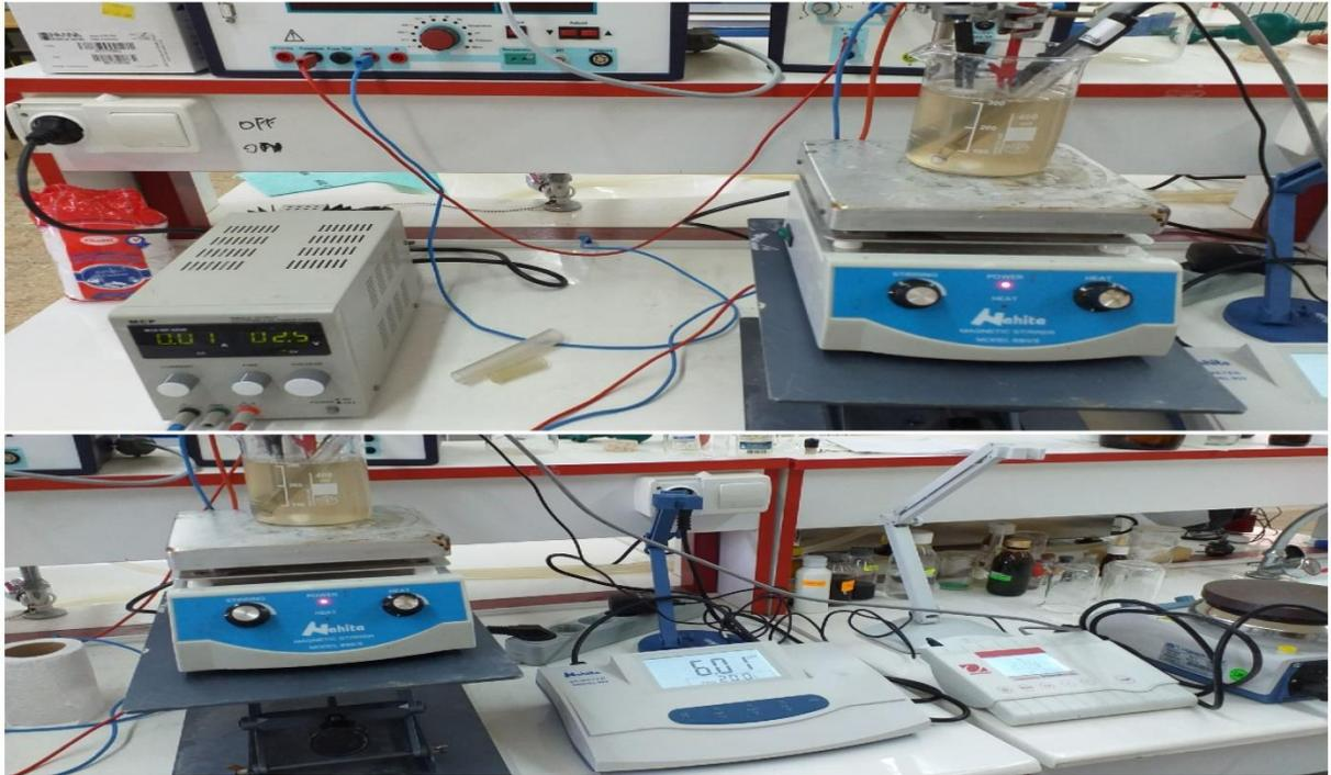
**Figure IV-15 :** Dispositif expérimental utilisé pour le traitement des eaux usées par électrocoagulation
