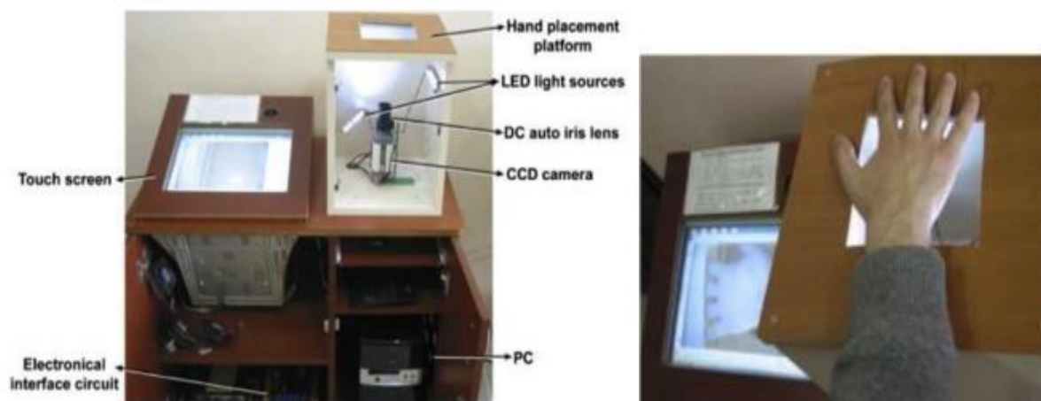
Figure II.3: Vue extérieure du système d'acquisition d'images palmaire et main posée sur la plateforme [21]
