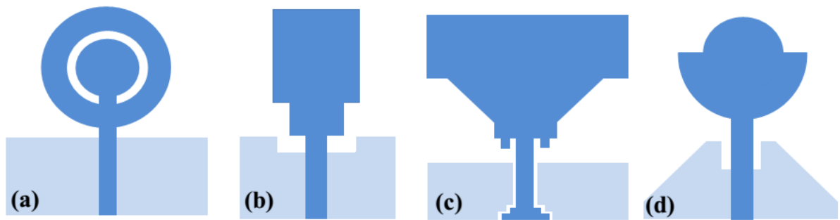
Figure II.12 .Structures des antennes patch monopole à large bande [23-26].
