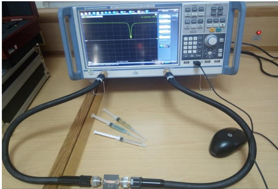
Figure III .14: le capteur connecter avec l'analyseur de réseaux vectoriel pour caractériser des liquides.
