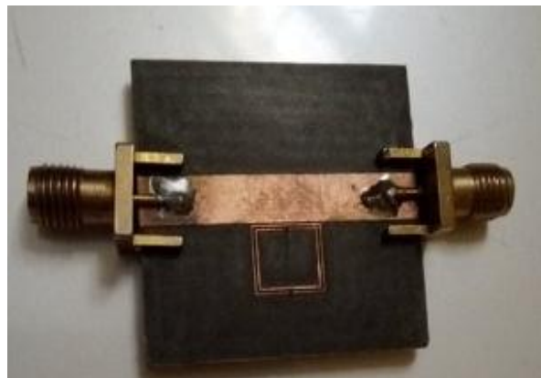
Figure III.13 : le capteur fabriqué avec deux connecteurs SMA.
