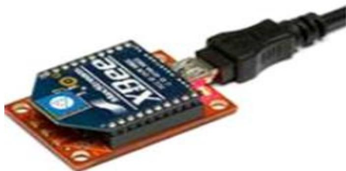
**Figure 2.9:**Insertion du module XBee sur la platine explorer USB.
