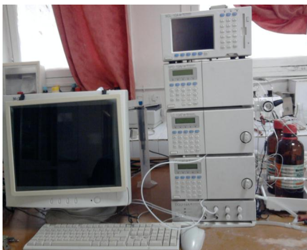
Figure III.1: HPLC analytique (Shimadzu, Japon, Université de Guelma) utilisé pour le dosage des polyphénols et de la caféine dans le café.
