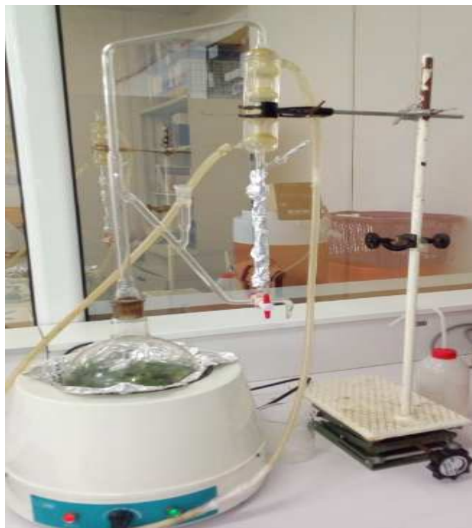
Figure 7 : Montage de l'hydrodistillation
