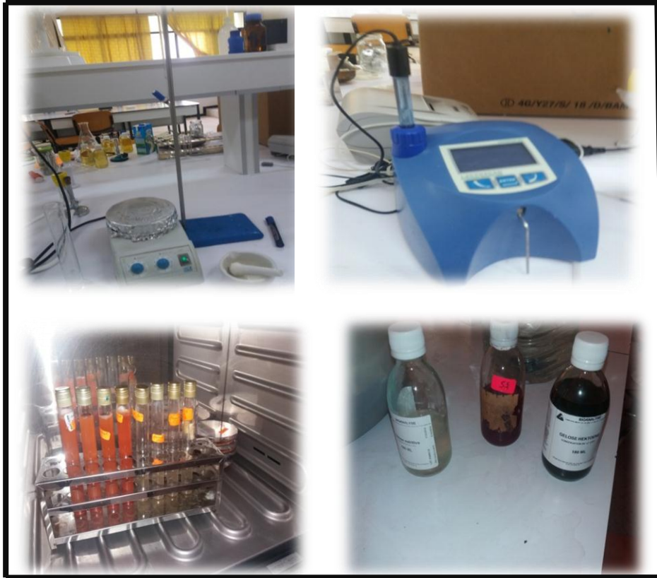
Figure 3 : A : Acidimètre + Agitateur ; B : Milkoscan ; C : Tubes a essai et Boites de Pétri dans l'incubateur ; D : géloses utilisées (SS, Hektoen , gélose nutritive).
