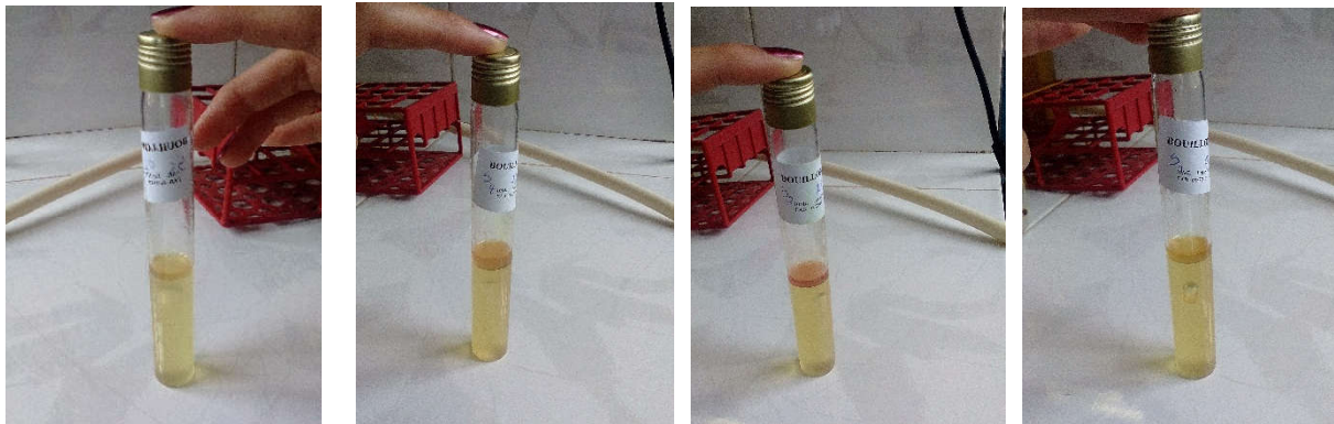
Photo III-2 : Absence des CT (à gauche) et présence des CT (à droite).
