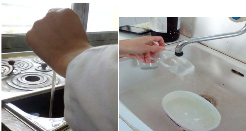
Photo II-12 : Méthode employée pour la caractérisation des ASR (à gauche : chauffage à 80 °C au bain-marie ; à droite : refroidissement brutal (choc thermique)).
