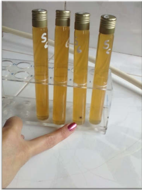
Photo II-13 : Exemple montrant la présence d'ASR (halo noir).
