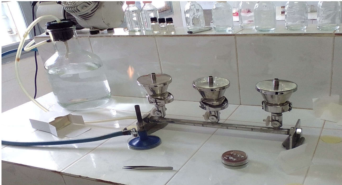
Photo II-8 : Appareillage utilisé pour la filtration sur membranes (rampe).
