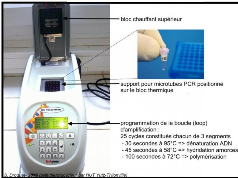
Figure 07: Image d'un thermocycleur et microtubes (7)
