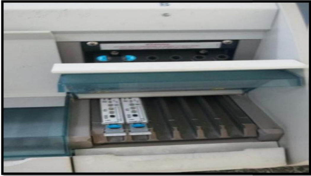
**Figure 14:** Mise en place des cartouches et cônes dans l'automate (Mabrouk, 2015)
