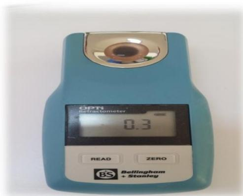
**Figure 02** : Réfractomètre portable.
