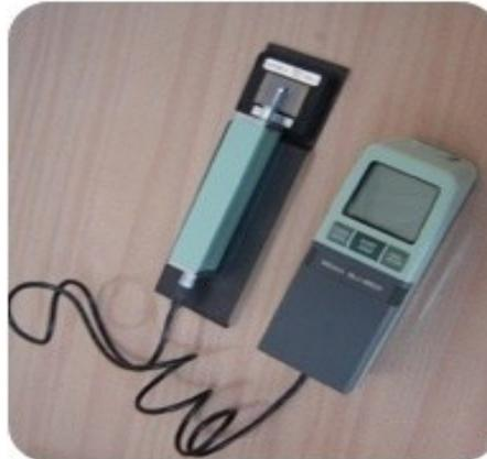
**Figure II.9.** Rugosimètre pour les mesures de la rugosité
