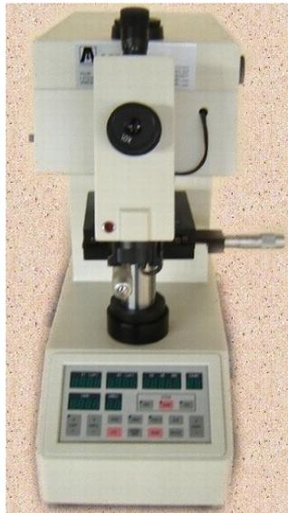
**Figure II.10.** Microduromètre pour les mesures de la microdureté
