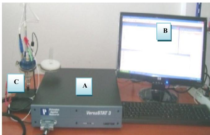
**Figure II.4.** Dispositif expérimental utilisé pour les tests de corrosions.
