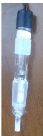
**Figure II.1.** Electrode au calomel saturée (ECS).
