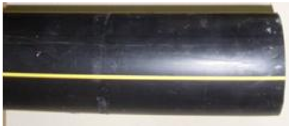
Figure III.1: Tube en PEHD100 utilisée pour la distribution de gaz naturel.
