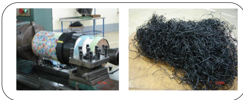
Figure IV.2: Montage du tube pendant une opération de chariotage et copeaux obtenus.
