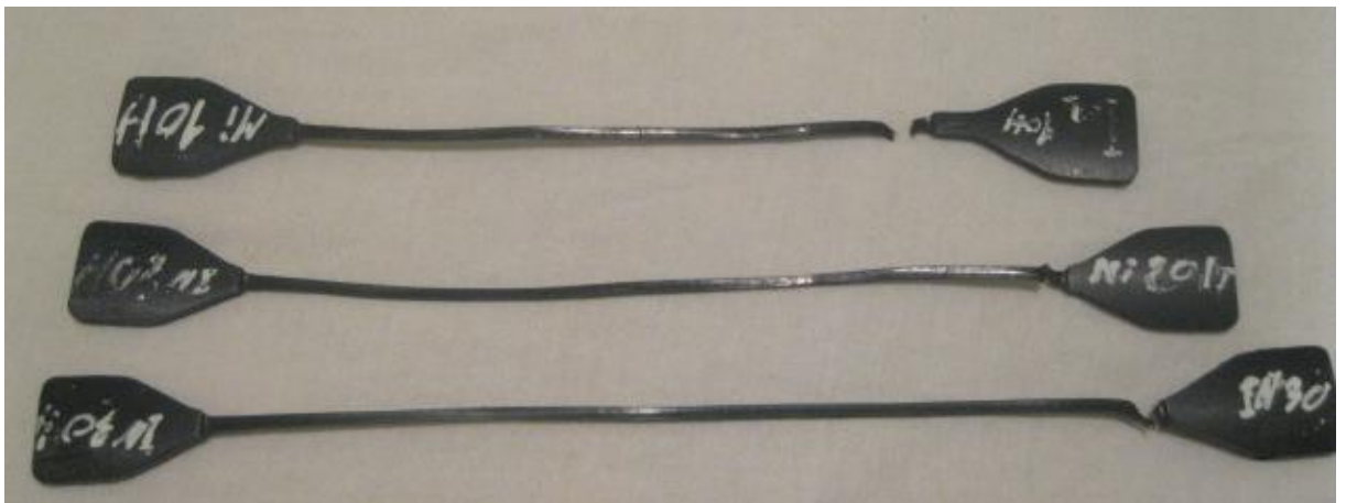
Figure IV.7: Eprouvettes après essais pour des durées de (10, 20 et 30 heures).
