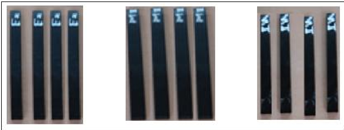
Figure IV.13: éprouvettes sans entailles avant essais.
