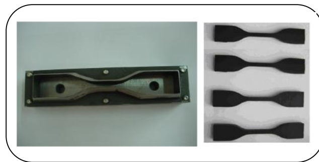
Figure IV.3: Emporte-pièce et éprouvettes obtenues.
