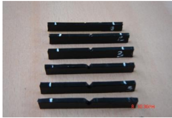
Figure IV.14: épreuves entaillée en forme de V avant essais.
