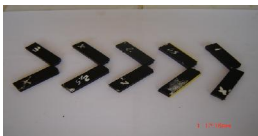
Figure IV.22: faciès de rupture de l'éprouvette de la couche extérieure entaillée après impact
