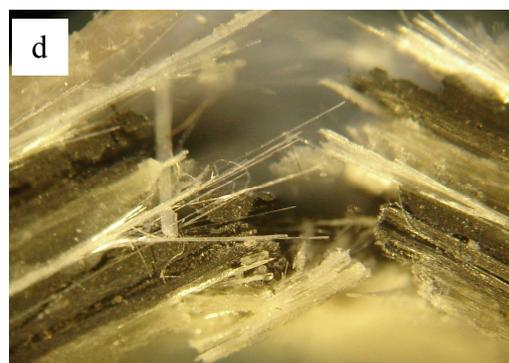
**Figure III.28.** Modes d'endommagement et faciès de rupture du stratifié **D**:
