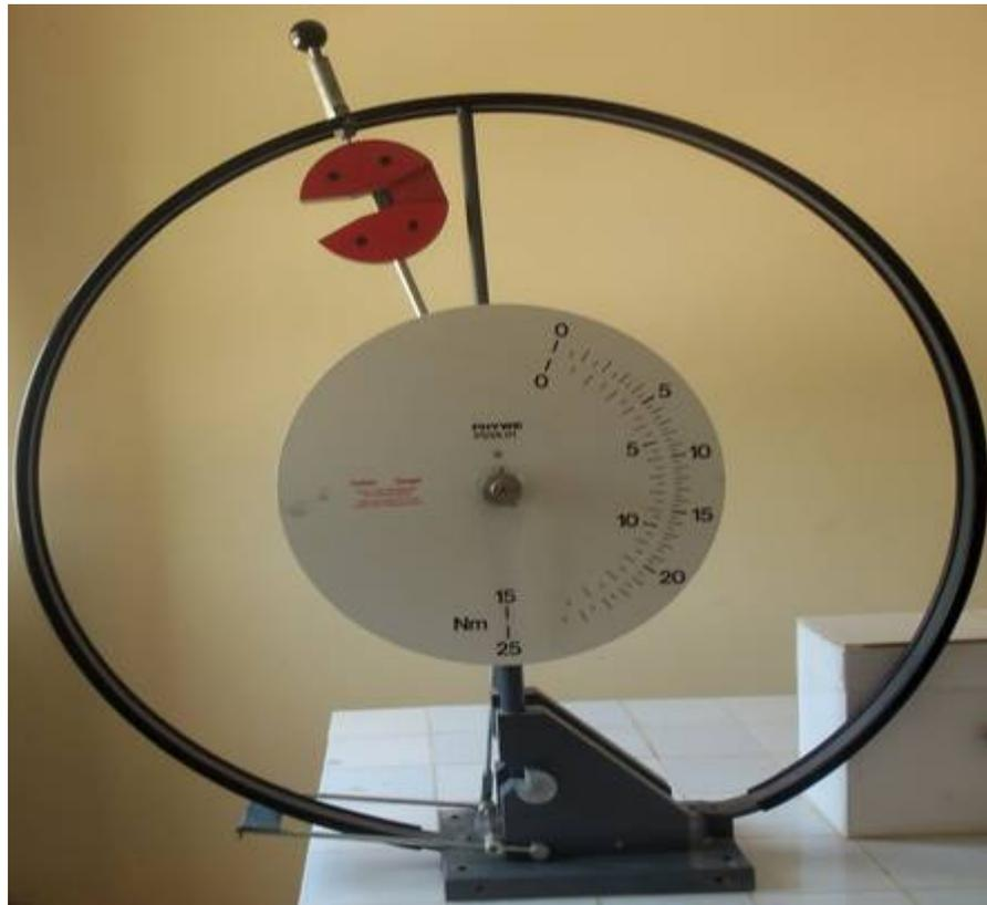
**Figure II.7.** Machine Charpy utilisée.
