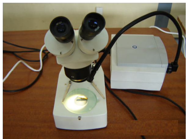
Figure 4.53 Microscope d'acquisition d'image de l'usure
