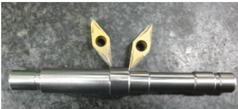
Figure 4.11: Axe de la roue avec les deux outils de chariotage(gauche et droit)
