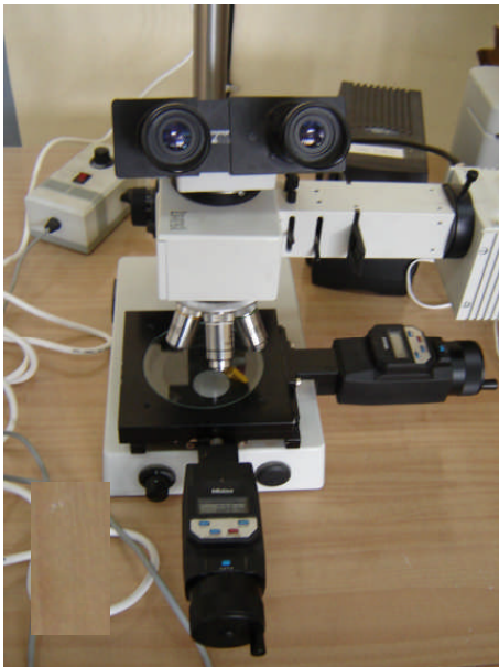
Figure 4.52 Microscope pour la mesure de l'usure
