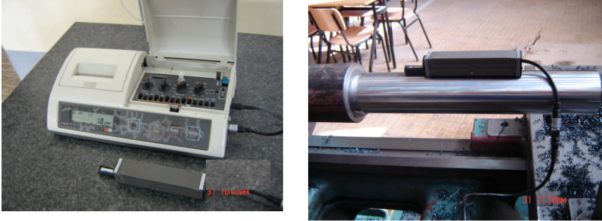
Figure 4.54 Mesure de la rugosité avec le rugosimètre portable mitutoyo
