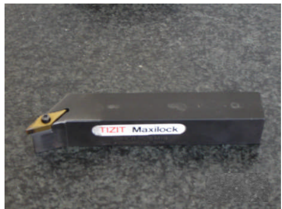
Figure 4.50 Outil de coupe utilisé monté sur le porte outil
