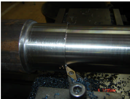
Figure 4.56 Un outil en GC415 usinant le 9SMn28K
