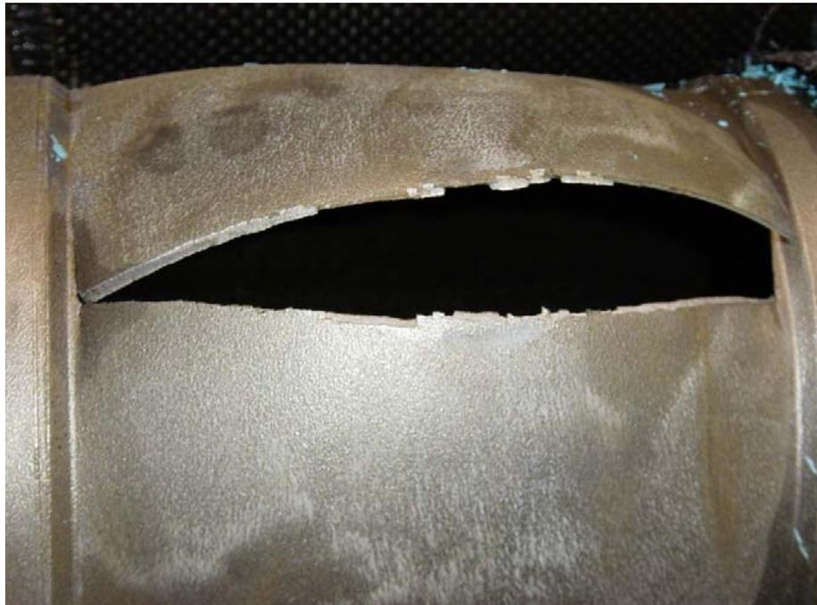
**Figure IV.28** Exemple d'un tube éclaté avec un défaut axisymétrique [4].
