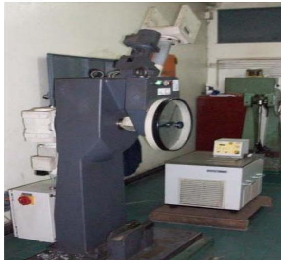
(b) La machine d'essai de charpy ROOL Amsler RKP
