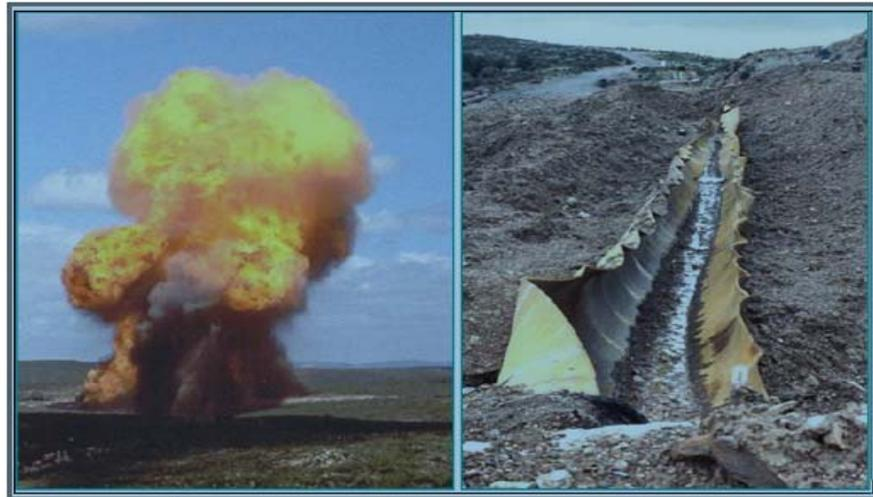
**Figure I.12.** Eclatement d'un pipeline [20].
