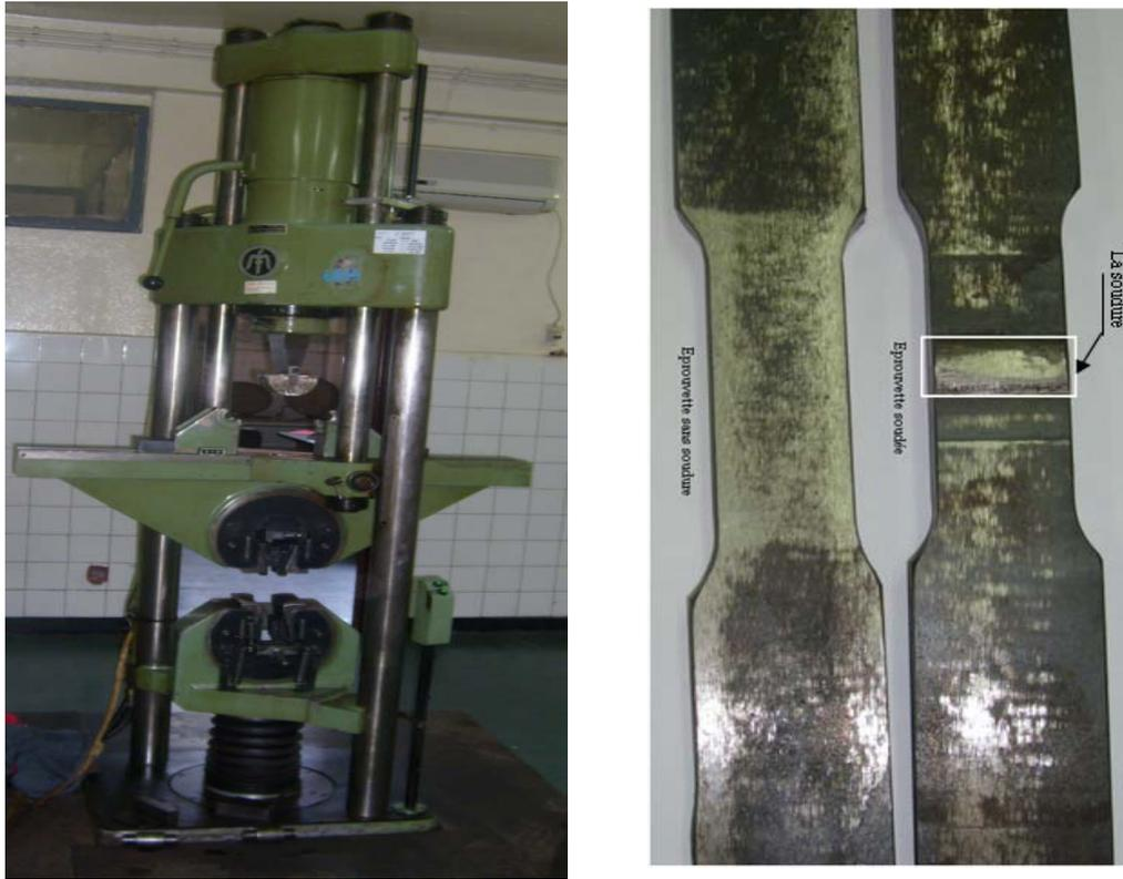
**Figure III.8** Machine d'essai universel et échantillon de traction.
