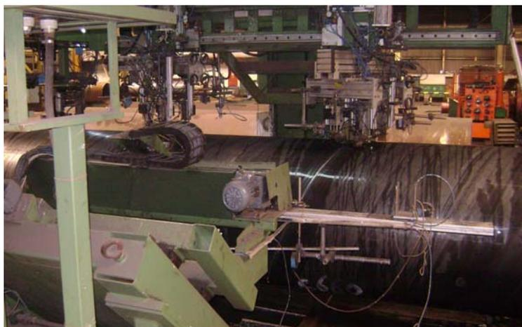
**Figure III.25.** Contrôle des tubes aux ultrasons.
