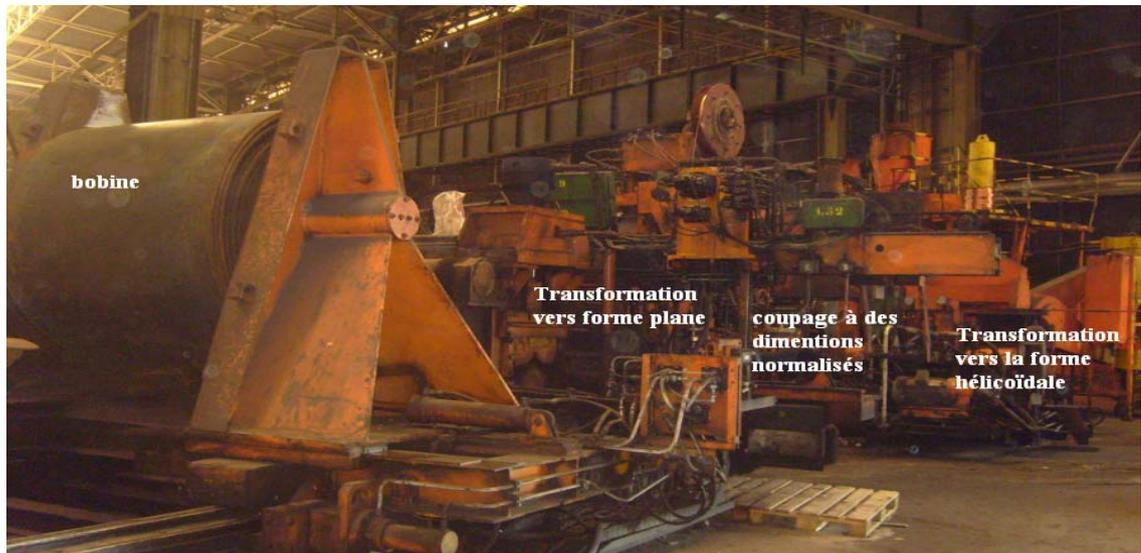
Figure III.1. Machine de préparation et de formage.
