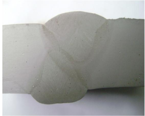
**Figure III.20.** Défauts de désaxage de la soudure sur un tube en acier X70.
