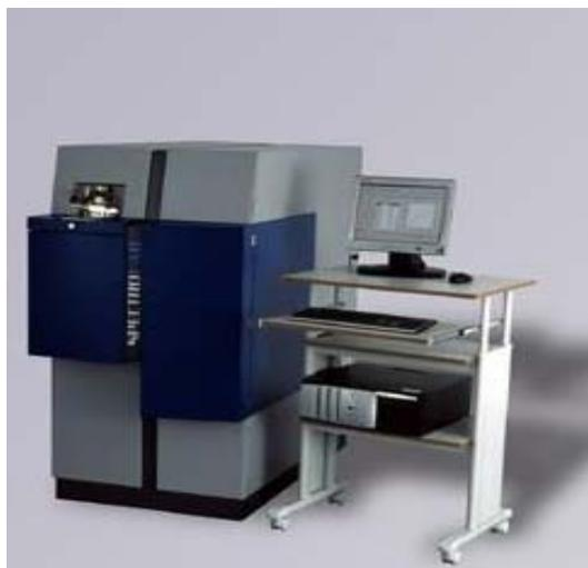
**Figure III.22.** SPECTRO LAB de mesure des teneurs des éléments chimiques du métal.
