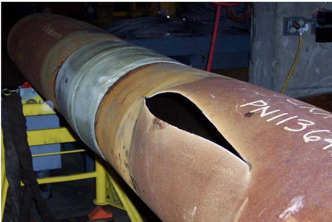
**Figure IV.32.** Rupture dans la section du matériau de base après un test d'éclatement [46].
