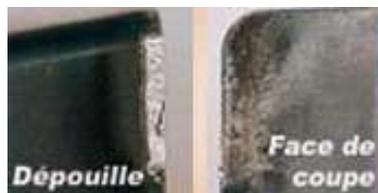
**Figure I-28.** *Usure par abrasion*
