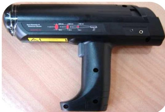
**Figure II-11.** *Pyromètre à infrarouge*
