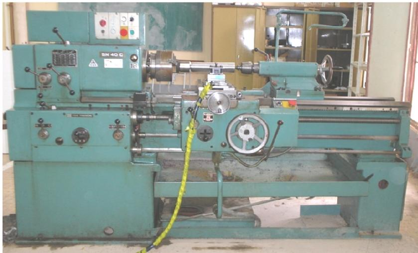
**Figure II-1.** *Tour parallèle modèle SN 40C*
