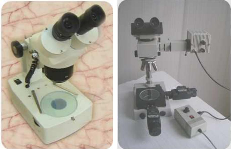
**Figure II-9.** *Microscope pour la mesure de l'usure*
