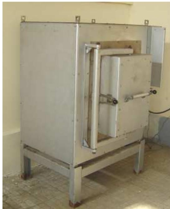
**Figure II-3.** Four à chambre électrique pour le traitement thermique des éprouvettes
