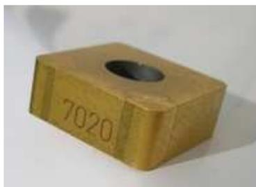
**Figure II-5.** Plaquette de coupe utilisée
