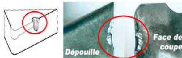
**Figure I-32.** Usure en entaille
