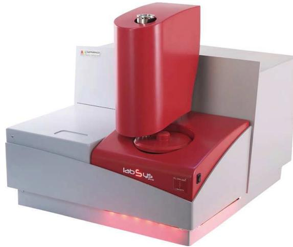
**Figure III.4 :** Analyseur enthalpique différentiel (DSC).
