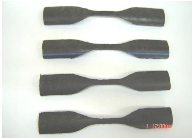
**Figure III.12 :** *Forme des éprouvettes de traction.*
