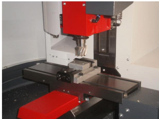
**Figure III.25:** Préparation des éprouvettes de choc sur une machine de fraisage de type EMCO mill55.
