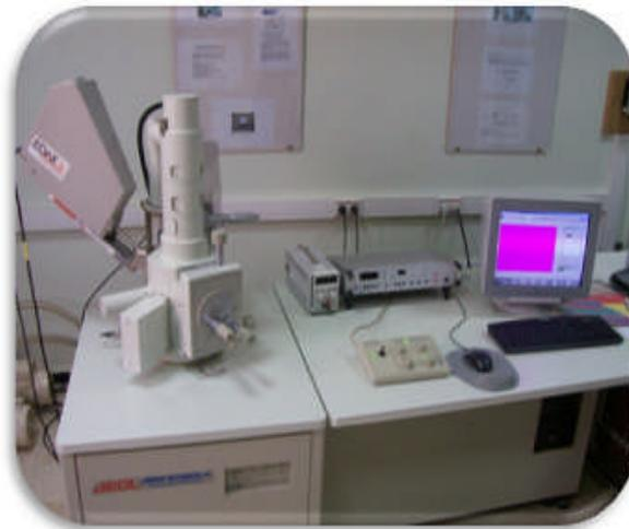
**Figure III.11 :** *Microscope Electronique à Balayage, type : Jeol JSM 6360 LV.*
