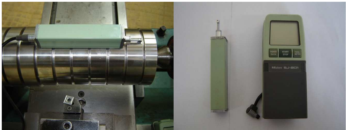
Figure II-10 : Mesure de rugosité sans démontage de la pièce.
