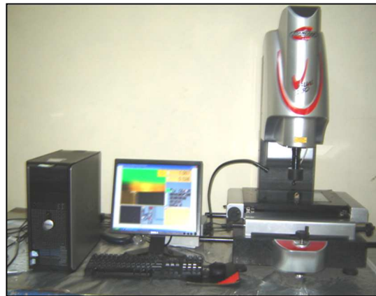
Figure II-9 : Microscope pour la mesure de l'usure.
