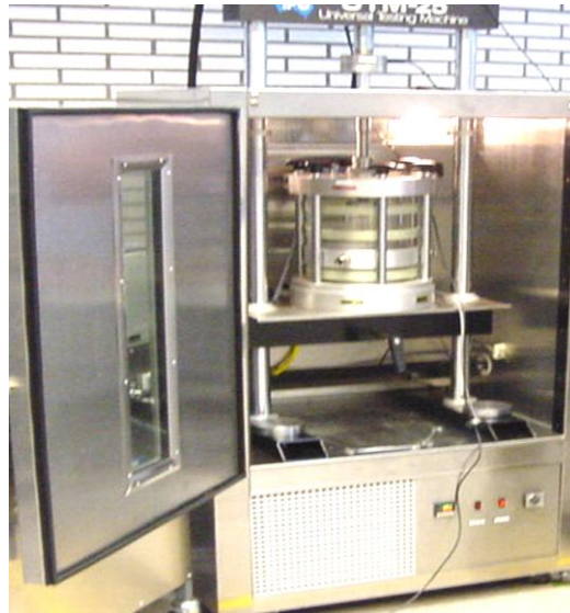
Figure.IV.3. Machine d'essai triaxial pour déterminer
