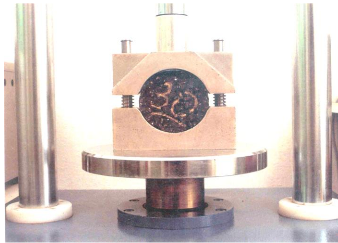
Figure .IV. 2. Machine de l'essai Marshall
