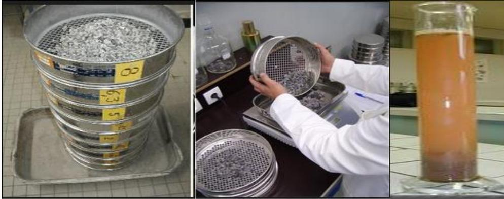
Figure 9 : Analyse granulométrique et équivalent de sable
