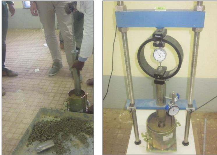
Figure 47 : Photos des essais Proctor et IPI
