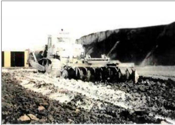
*Figure 32 : Charrues à disques de 5 tonnes*
