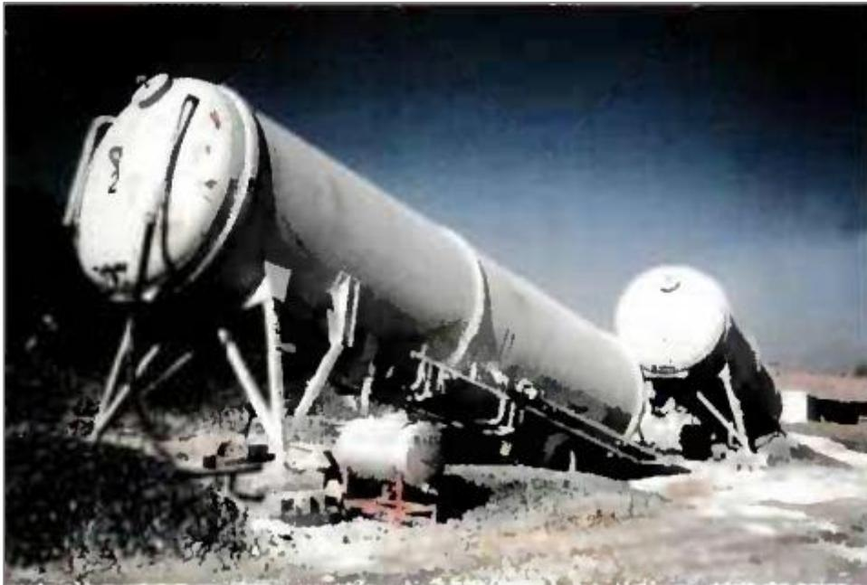
*Figure 29 : Silos mobiles de 2 x 45 tonnes*
