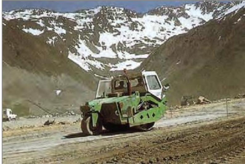
*Figure 36 : Un compacteur vibrant tandem-transversal*
