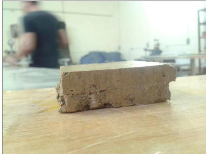
*Figure 59 : Photo de notre sol après l'essai de cisaillement*
