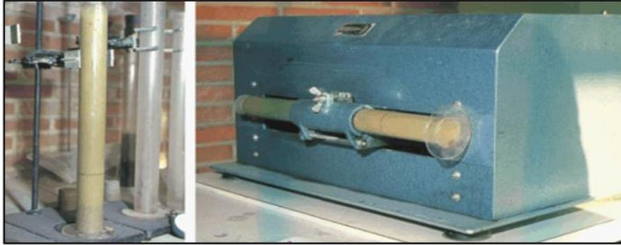
Figure 13 : Essai équivalent de sable
