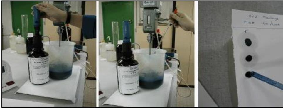
*Figure 12 : Essai au bleu tâches auréolées*
