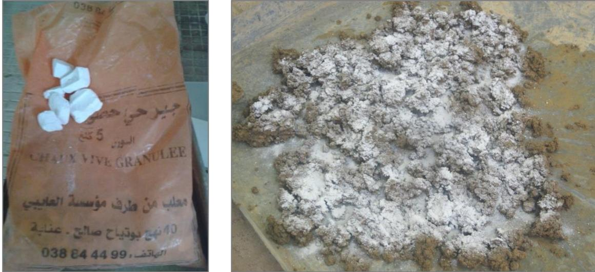
Figure 48: Photos montrant l'application de la chaux vive pour le traitement
