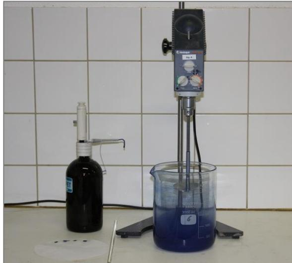
Figure 42: dispositif pour l'essai VBS
