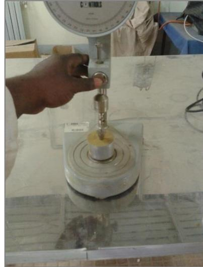
Figure 43 : Photo du cône de pénétration
