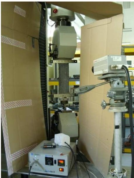
Fig.5.5 Machine de traction utilisée pour des tests de Bias extension test à l'INSA de Lyon
