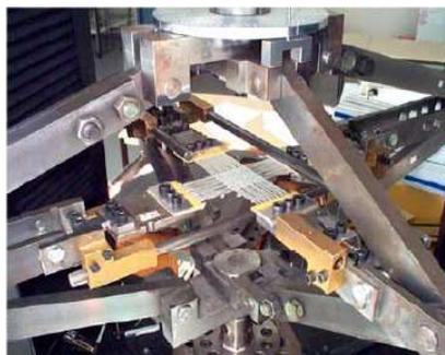
*Fig.1.14 Dispositif d'un essai de traction bi-axiale*
