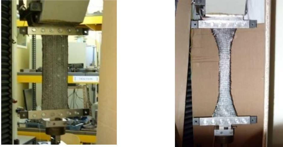
Fig. 1.21 Essai de cisaillement Bias extension test sur éprouvette en NCF
