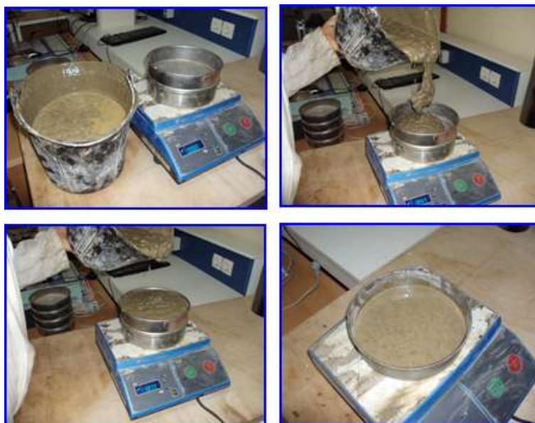
Figure .IV.13 : Photos illustrant l'essai de stabilité au tamis.
