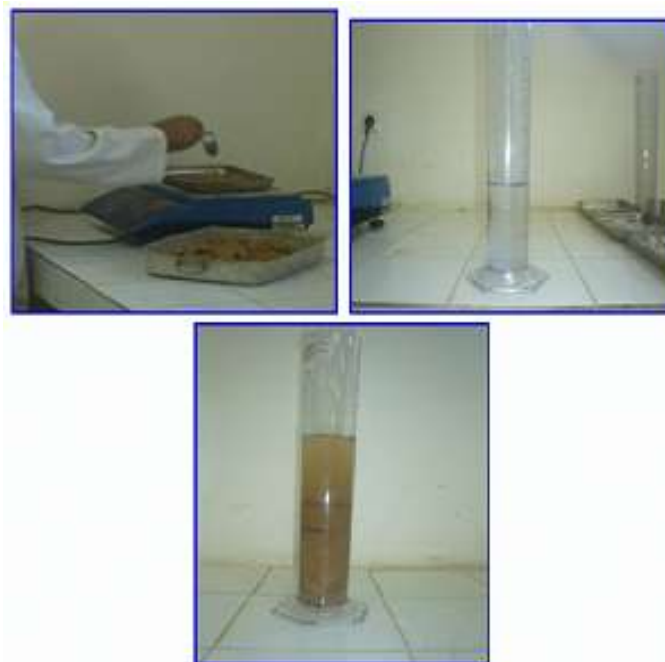
Figure .IV.7 : Mesure de la masse volumique absolue du sable
