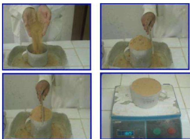
Figure .IV.7 : Mesure de la masse volumique apparente du sable
