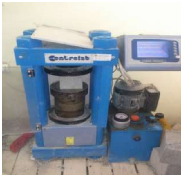
Figure .V.3 : Presse hydraulique utilisée pour essai de compression
