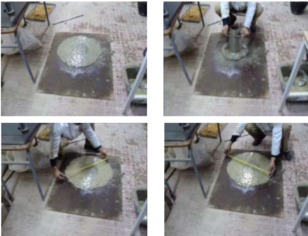
Figure .IV.11 : Mesure de l'étalement du BAP
