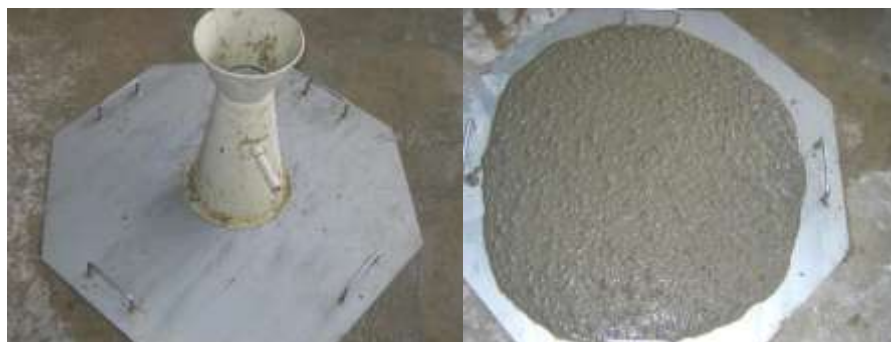
Figure .II.6 : Essai d'étalement au cône d'Abrams (slump flow)
