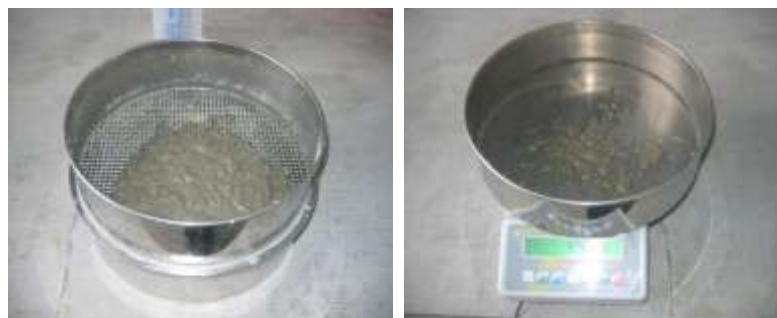
Figure .II.11 : Essai de stabilité au tamis
