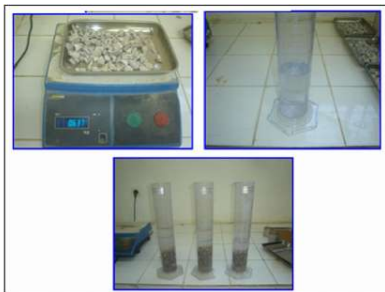
Figure IV.2 : Mesure de la masse absolue
