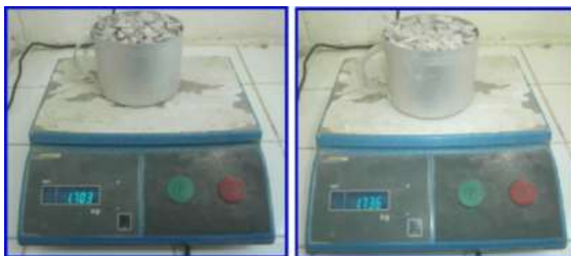
Figure .IV.1 : Procédé utilisé pour la mesure de la masse apparente du gravier
