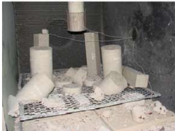
Figure .III.24 : Éclatement explosif des BAP durant un feu ISO 834 [52]
