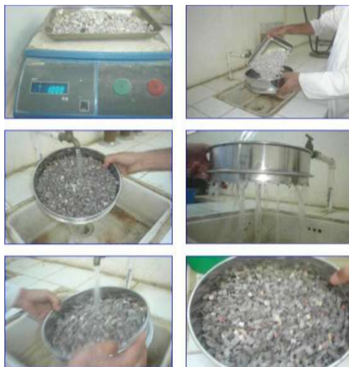
Figure .IV.4 : Mesure de la propreté des graviers
