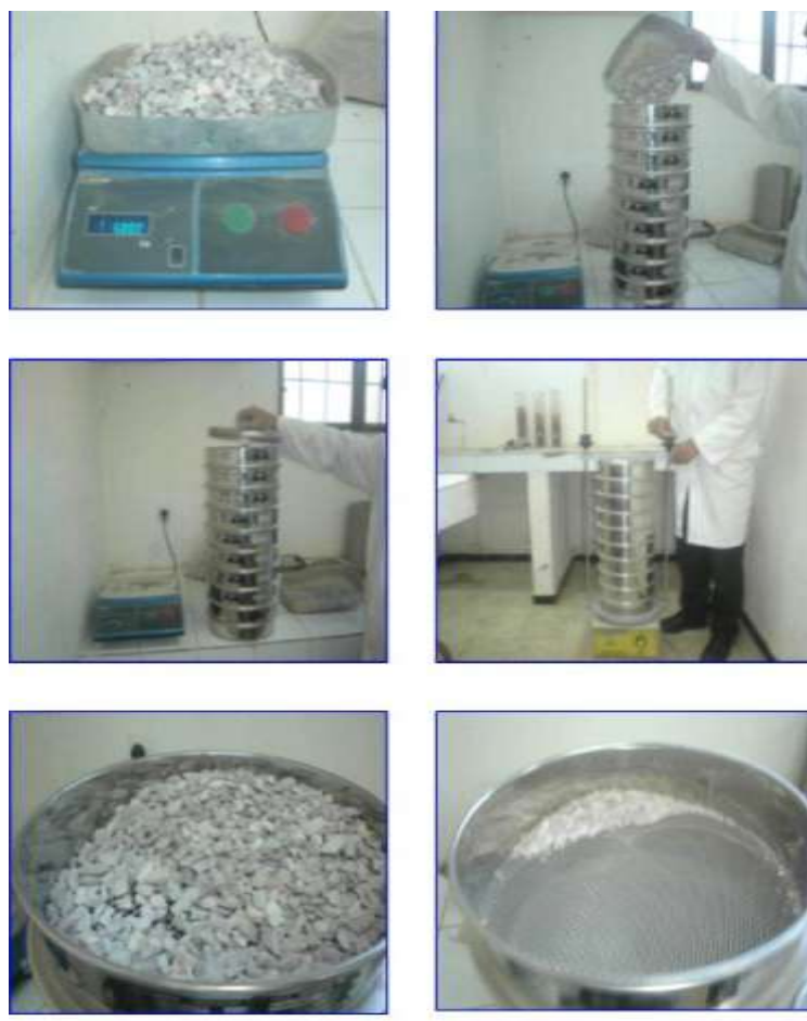
Figure .IV.5 : Analyse granulométrique.
