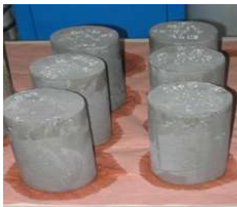
Figure .II.14: Parement d'un béton autoplaçant.
