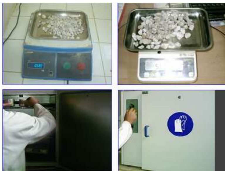
Figure .IV.3 : Détermination de la teneur en eau
