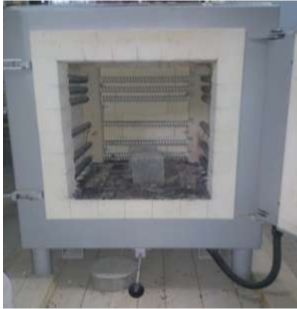
Figure .V.1 : La disposition des éprouvettes dans l'étuve.
