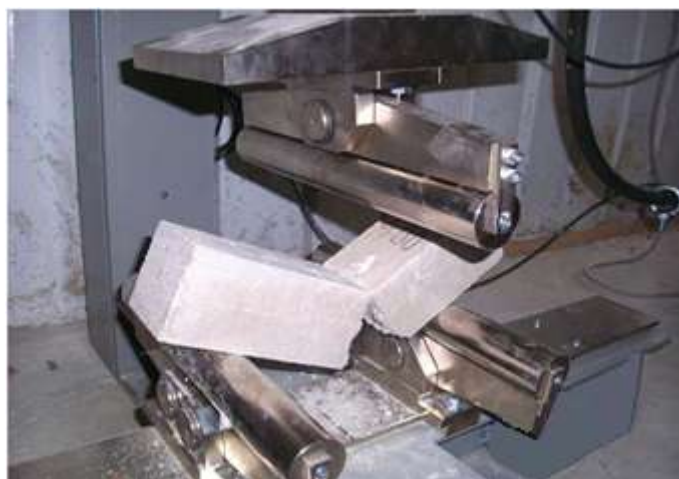
Figure .IV.15 : Dispositif de l'essai de traction par flexion
