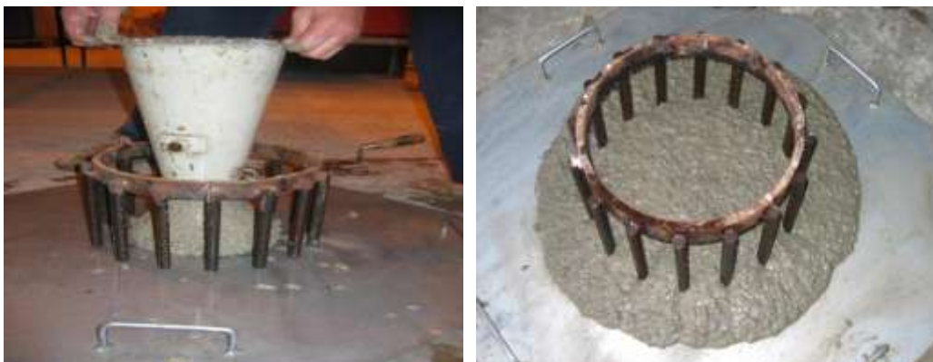
Figure .II.7 : Anneau japonais – Laboratoire GC de Polytech'Orléans.
