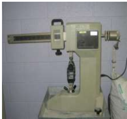
Figure.II.17 : Mesure de la résistance à la traction par flexion des (4x4x16) cm
