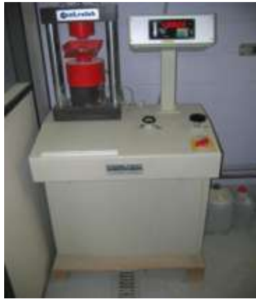
Figure.II.18 : Mesure de la résistance à la compression sur demi-prismes
