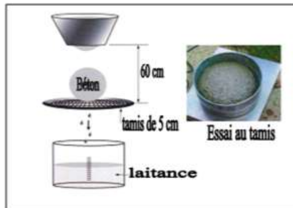
Figure .II.10 : Représentation de l'essai de stabilité au tamis
