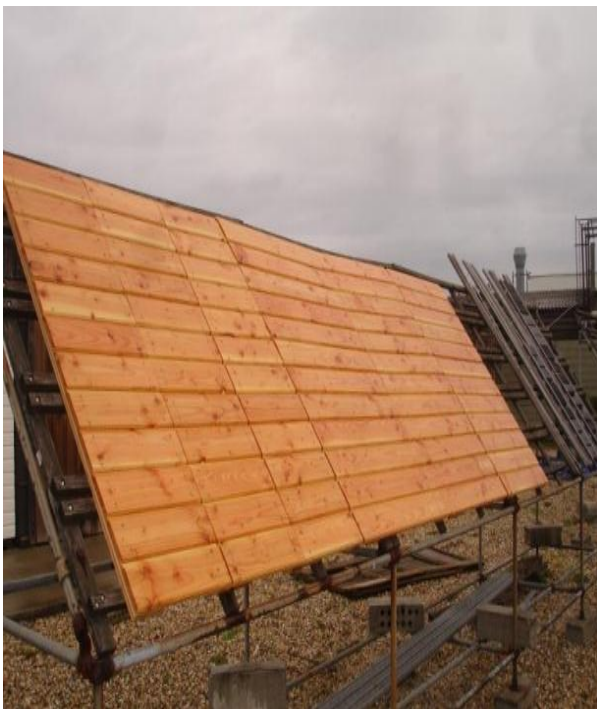
Figure 1-7: Essais de performance de réaction au feu des lames de bois massif
