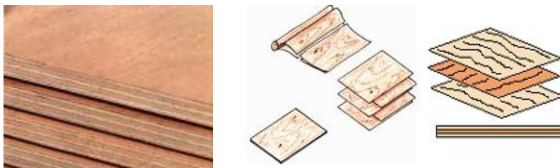
Figure 2-15: principe de fabrication du contre-plaqué
