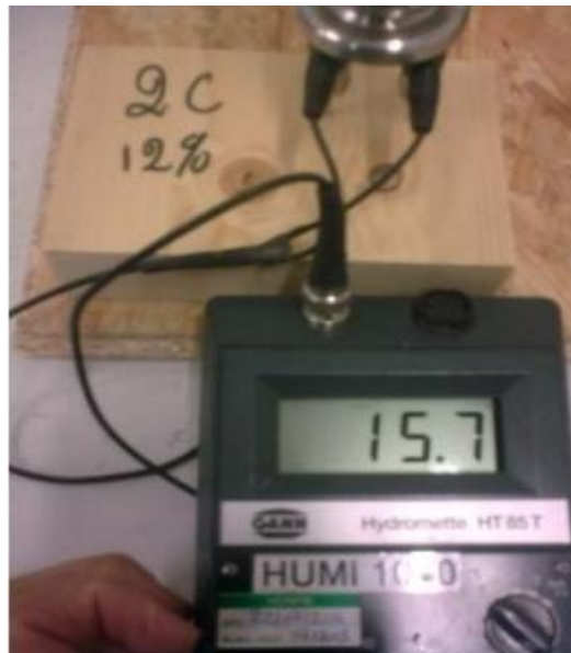
Figure 1-4: Prise de mesure du taux d'humidité dans les lames de bois
