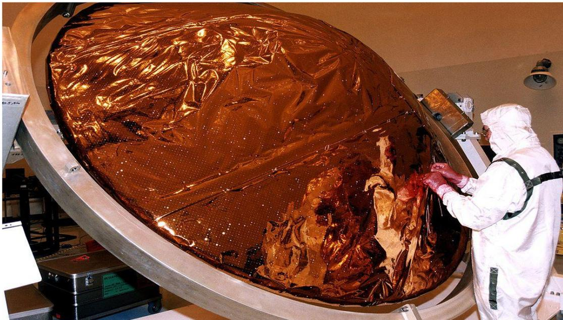
**Figure 15 :** Solant thermique sur la sonde spatiale Huygens.
