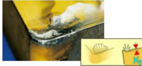
Figure I.12. Usure en cratère de la surface d'attaque [4].
