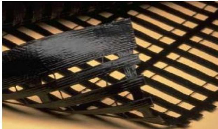
**Figure 3.29** Géogrille uni-axiale
