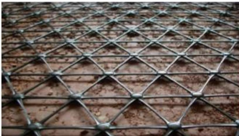
**Figure 3.31** Vue en plan d'une géogridde tri-axiale
