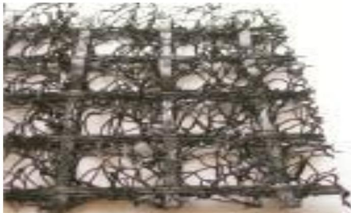
**Figure 2.2** : Exemple de géocomposite
