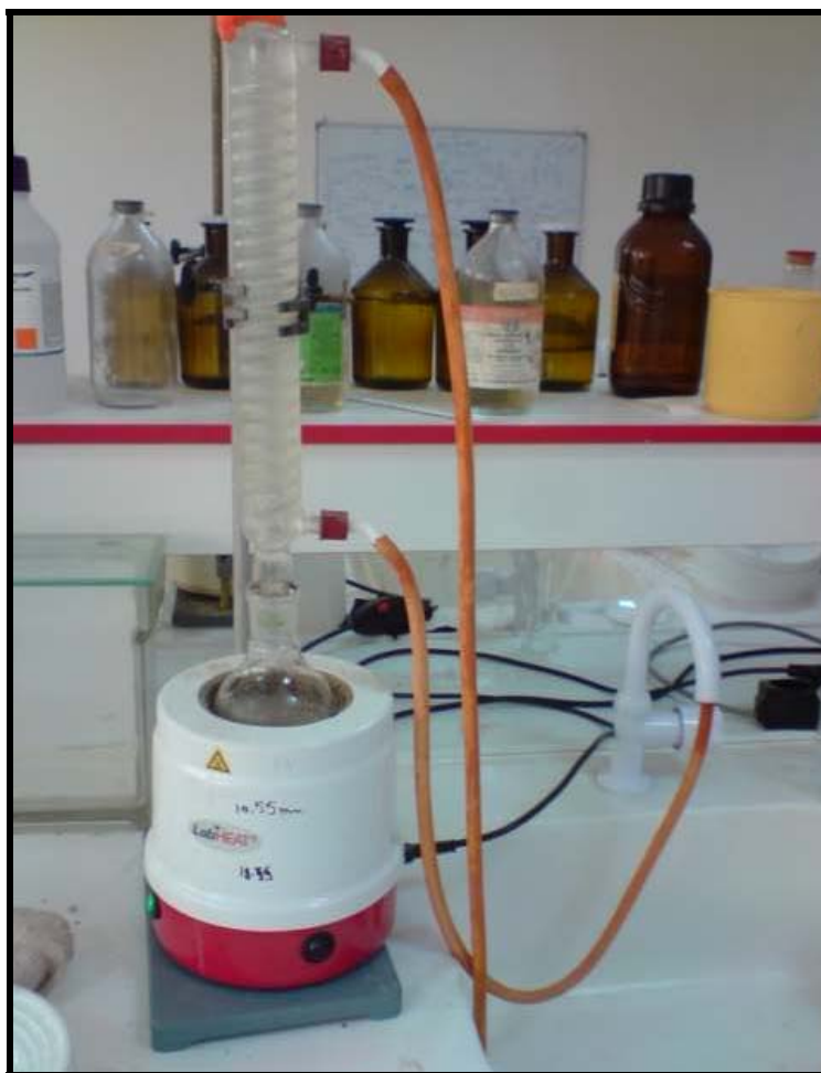
Figure V – 2 : Expérience de la détermination de la demande chimique en oxygène (DCO).
