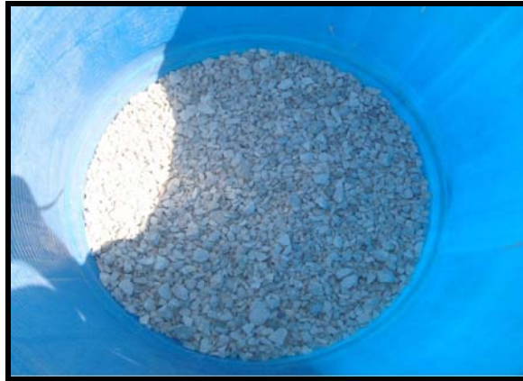
Figure IV – 3 : Couche de gravier.
