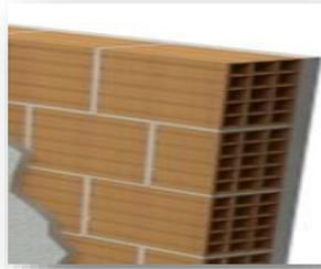
**Figure II-9 : Mur simple cloison.**
