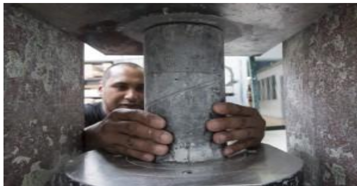
Figure IV.2 Les essais sus béton (compression traction ...)
