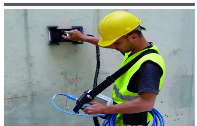
Figure 2.17: Mesure du potentiel de corrosion
