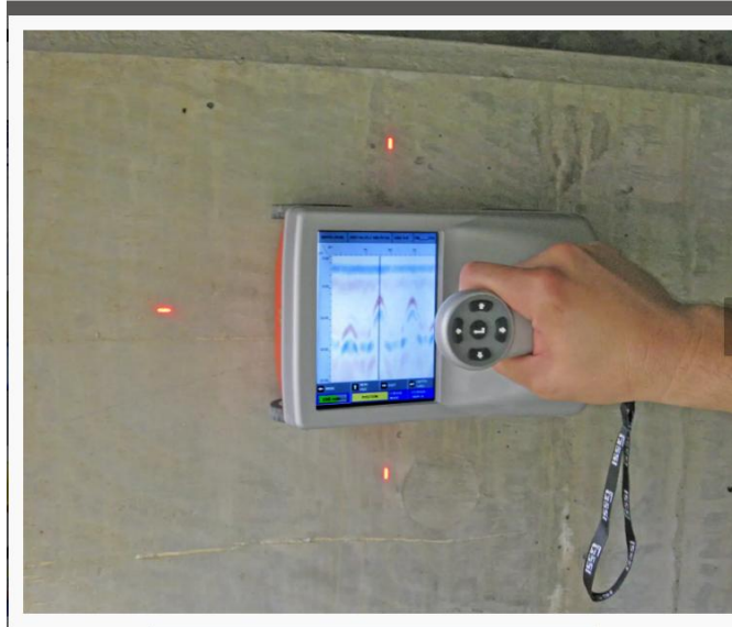
Figure II.14 : Mesures par ultrason
