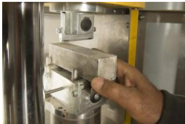
Figure IV.4 : Essai de flexion sur ciment
