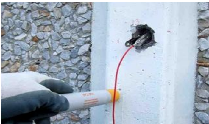
Figure 2.17: Mesure du potentiel de corrosion
