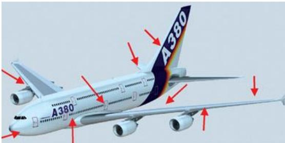
**Figure 1.22** Applications en transport aérien (les flèches repèrent les zones où les sandwichs sont employés)
