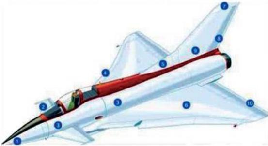
**Figure 1.21** Applications en aéronautique (les chiffres repèrent les zones où les sandwichs sont employés.
