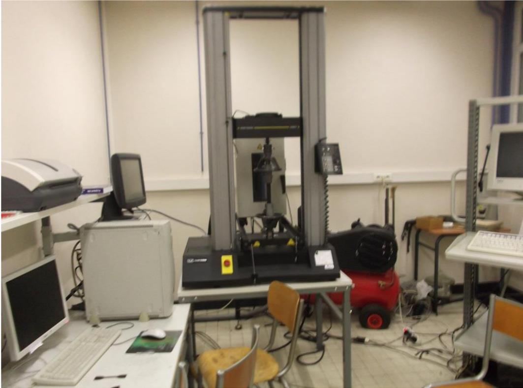
**Figure 2.3** Dispositif expérimental de la compression.
