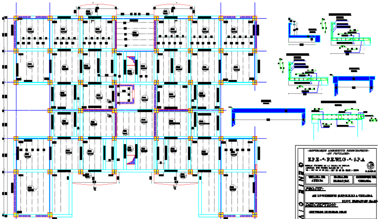
Figure III-16 : Plan de coffrage de niveau terrasse
