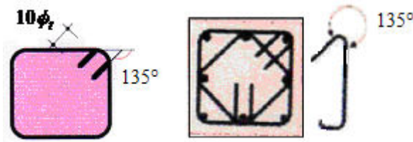
Figure VI.5 : Dispositions des cadres dans les poteaux.
