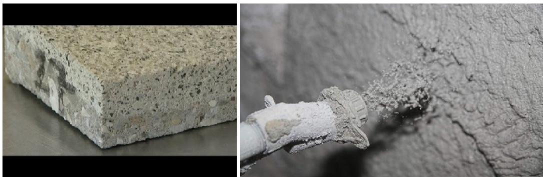
Figure III.37 : Bloc de béton et un mortier à base d'un ciment photo-catalytique.
