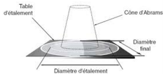
Essai au cône d'Abrams
