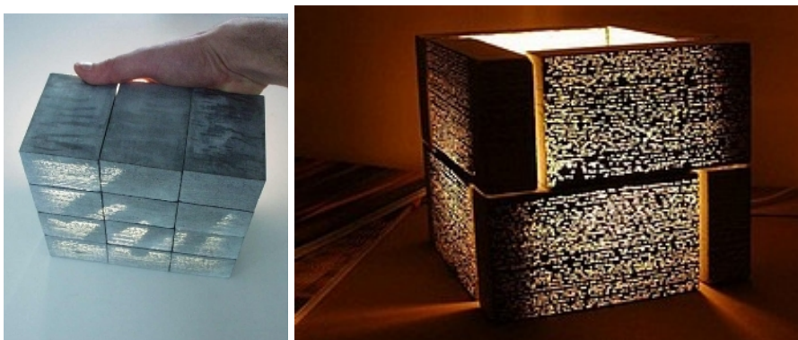
Figure III.30: La fibre optique dans le béton
