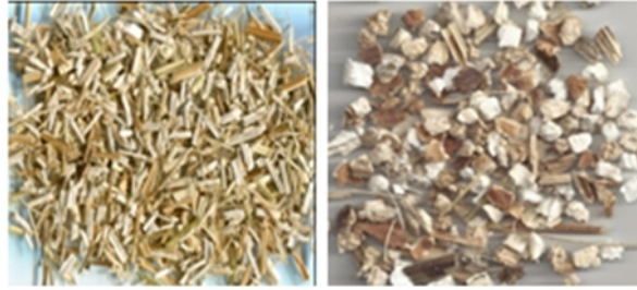
Figure II.4 : Granulats obtenus par broyage des tiges de chanvre et de tournesol
