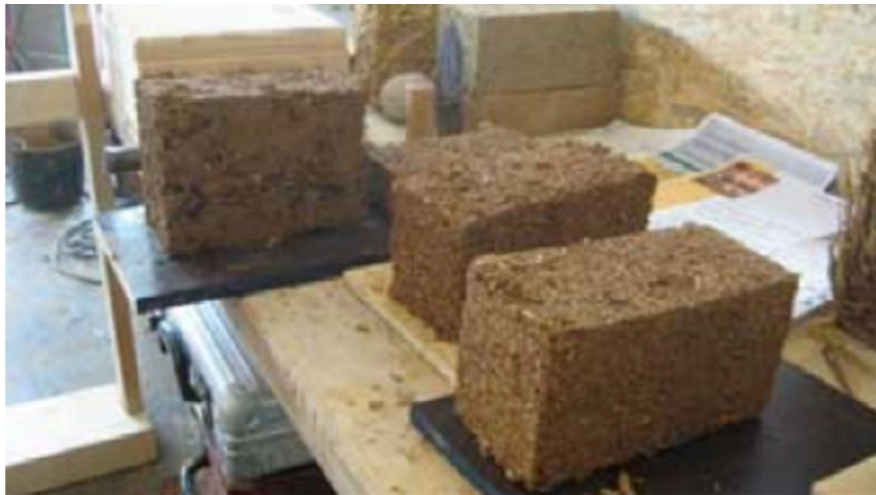
Figure II.21 : des blocs de « terre-paille », en remplissage d'une ossature.
