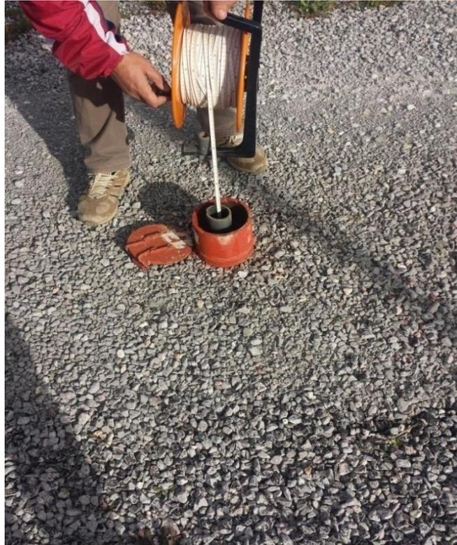
Fig. 4.7 : Photo d'un piézomètre dans le barrage de Zit El Emba
