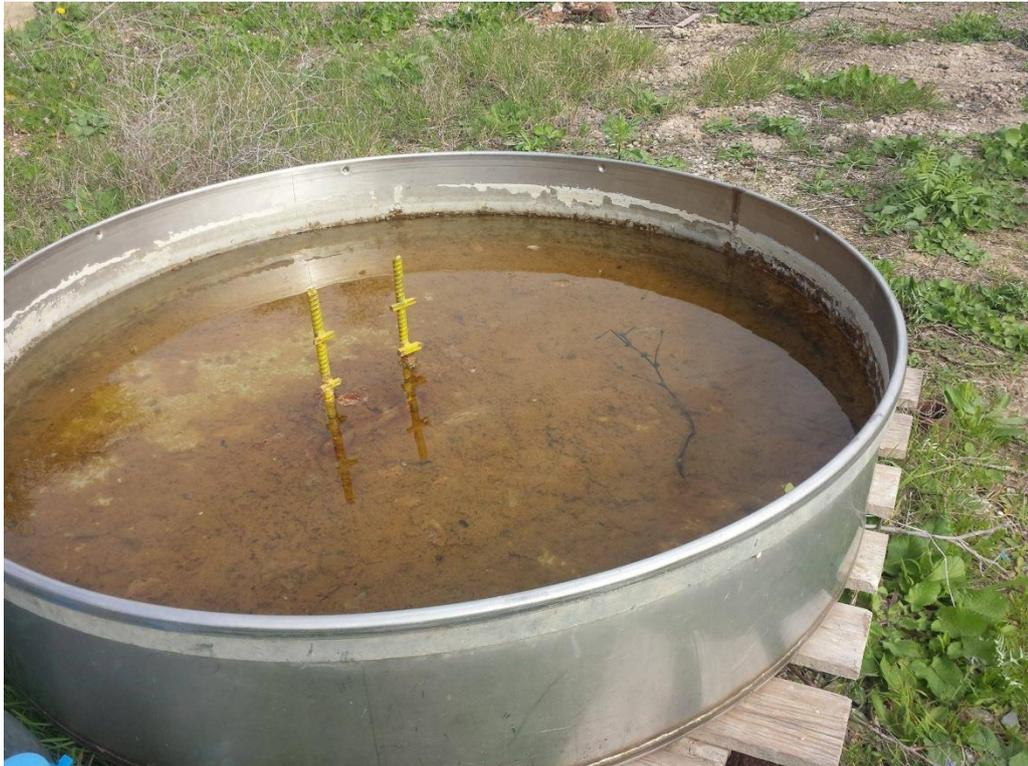
Fig. 2.3 : Photo du bac de type classe A installé au barrage de Zit El Emba
