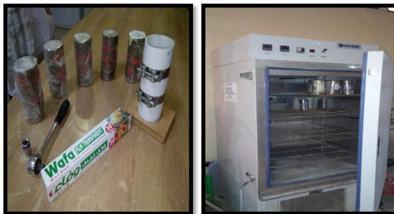
Figure 73 : Photos du moule et de quelques éprouvettes préparées
