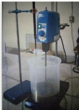
*Figure 57 : Dispositif pour l'essai VBS*
