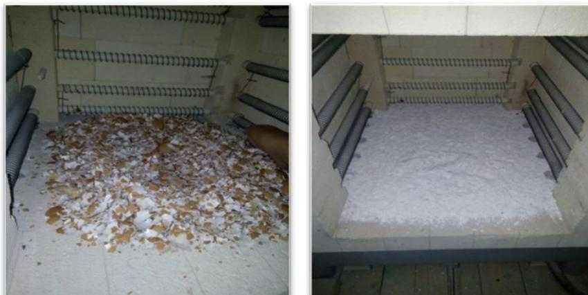
*Figure 69 : Photos de la coquille avant (à gauche) et après (à droite) calcination*
