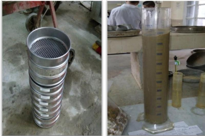
*Figure 52 : Analyse granulométrique par tamisage et par sédimentométrie*
