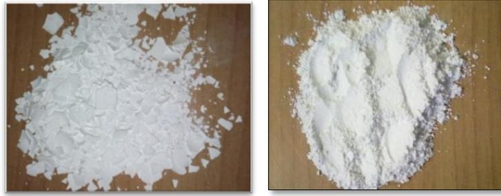
Figure 70 : Photos de la coquille calcinée avant (à gauche) et après (à droite) broyage
