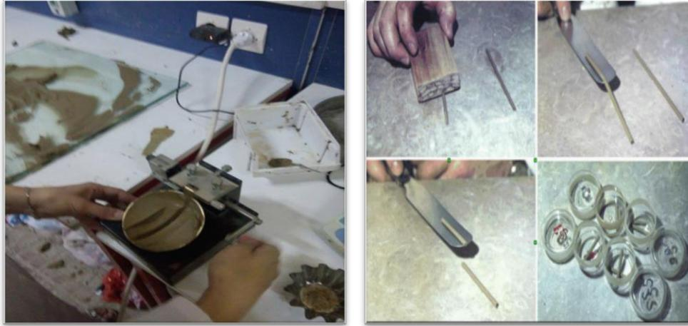
Figure 55 : la coupelle de Casagrande (à gauche) l'essai de rouleau (à droite)
