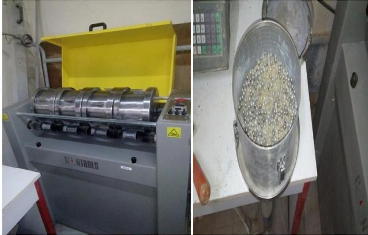
Figure 65 : Photos du broyage du laitier dans l'appareil Micro Deval
