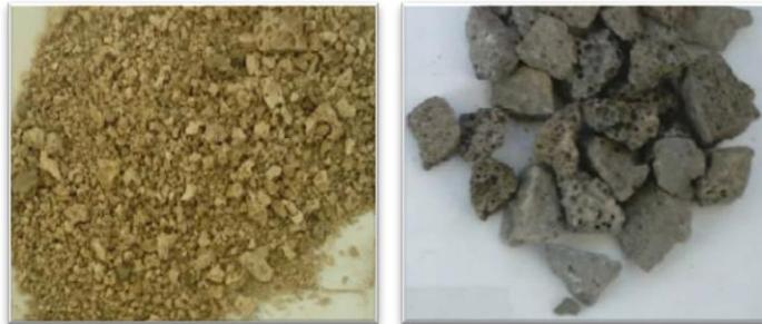
Figure 29 : laitier granulé (à gauche) et laitier cristallisé (à droite)
