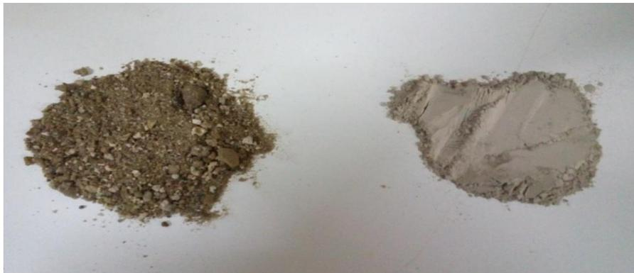
Figure 66 : Le laitier granulé avant et après broyage
