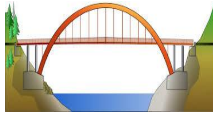
pont à tablier intermédiaire
