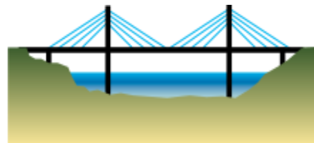
Pont à haubans
