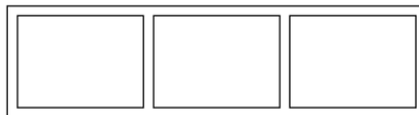
Figure II.7 : schéma d'un dalot triple.
