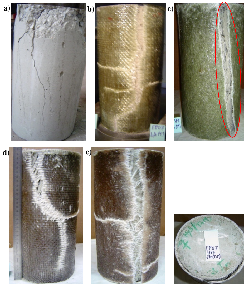
Figure III.8. Modes d'endommagement du béton de contrôle comparés avec les éprouvettes renforcées par différents types de renforts.
