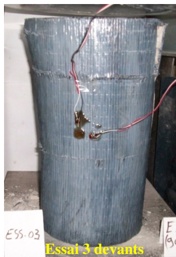
Figure IV.5. Modes d'endommagement et faciès de rupture des colonnes confinées par des enveloppes en PRFC orientées à : a) (0 2 /90 2 ), b) (90 2 /0 2 ), c) (0/90) s et d) (90/0) s .
