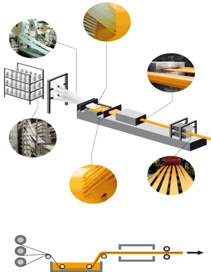
Figure I.16. Technique de fabrication des composites par pultrusion et leur schématisation. [ http://old.fibrolux.com/fr/main/profiles-prv/pultrusion/ ].
