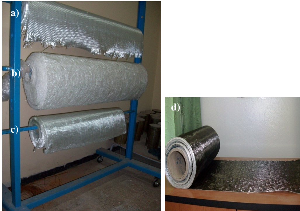
Figure II.10. Différents types de renforts utilisés: a) Tissu (T1) (densité surfacique de 500 \text{ g/m}^2 ) ; b) Mat (densité surfacique de 300 \text{ g/m}^2 ) ; c) Tissu (T2) (densité surfacique de 300 \text{ g/m}^2 ) et d) Nappe unidirectionnel en fibre de carbone.
