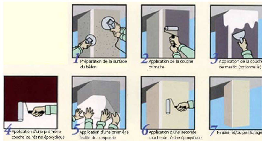
Figure I.19. Procédure de la mise en œuvre des feuilles en composites [CRO-06].
