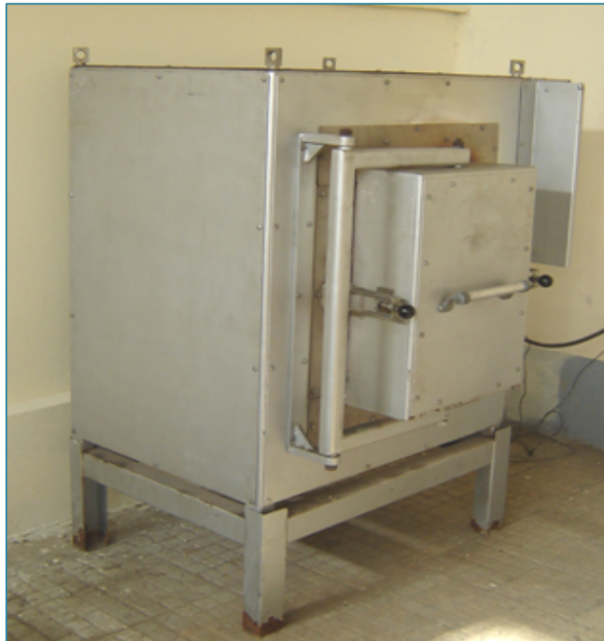
Figure II.5: Four à chambre électrique pour le traitement thermique des éprouvettes.
