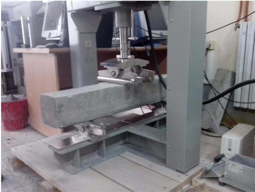
Figure II.8: photo de l'essai en flexion quatre points.
