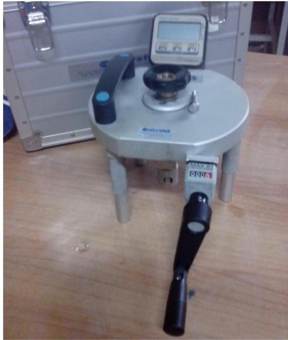
Figure II.4: Photo du dynamomètre de traction utilisé.
