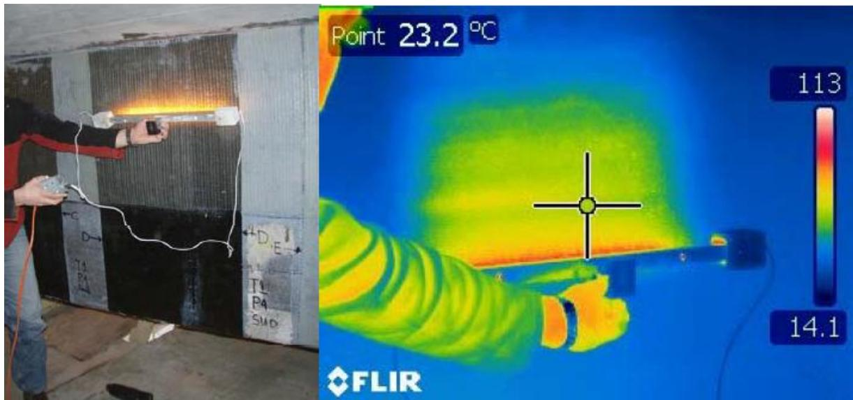
**Figure V.10:** contrôle par thermographie infrarouge d'une réparation par tissu en fibre de carbone. [Site.1]
