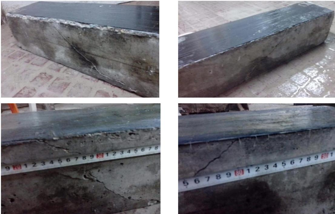
**Figure III.23:** Les différentes lignes de rupteur dans les poutrelles.
