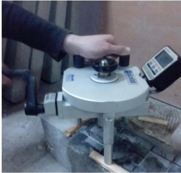
Figure II.10: Photo de l'opération d'essais d'arrachement.
