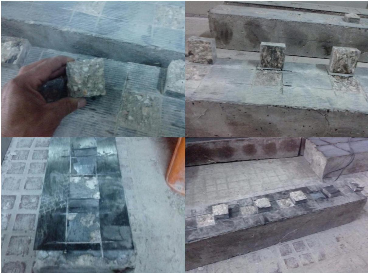
Figure II.11: Photos des ruptures lors des essais destructifs (arrachement).
