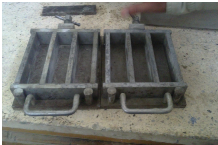
Fig.5.11: Moules normalisés “éprouvettes 4\times 4\times 16 ”.
