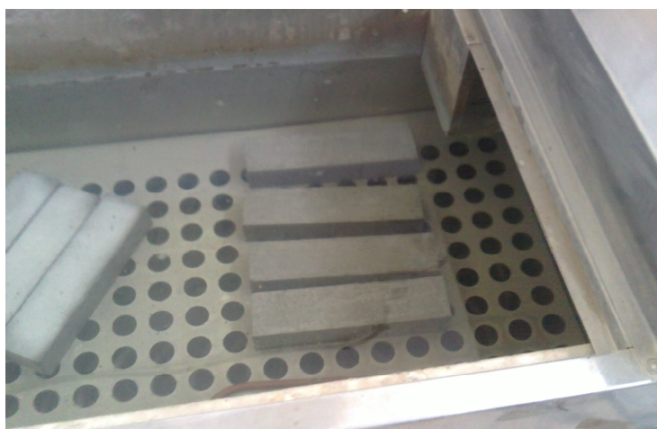
Fig.5.17: Les éprouvettes dans un bassin d'eau.
