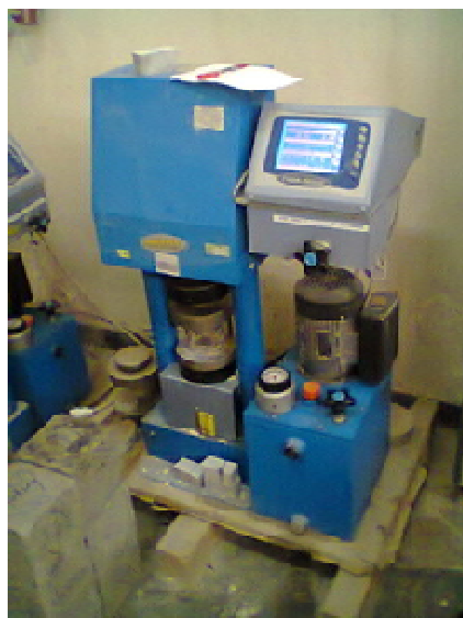
Fig.5.13: Machine d'essais à la compression.
