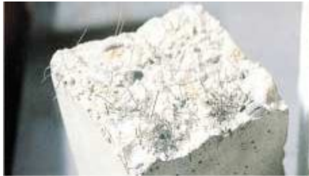
Fig.4.1: Eprouvette avec des fibres. [39]
