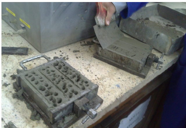
Fig.5.15: Arasement de mortier dans le moule.
