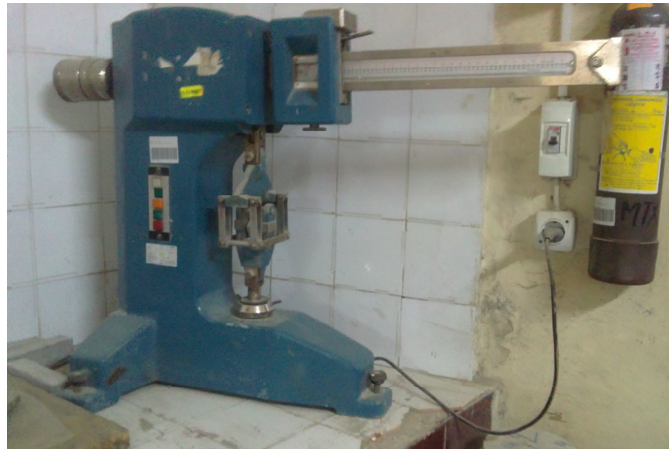
Fig.5.12: Machine d'essais de résistance à la flexion.
