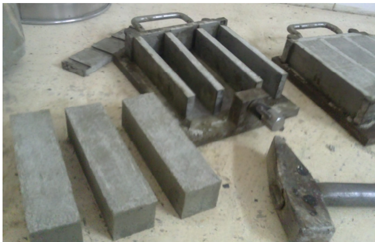
Fig.5.16: Démoulage des éprouvettes.
