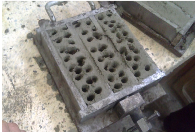
Fig.5.14: Moule rempli de mortier pendant le choc.
